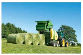
Des dimensions variables signifient que l'on peut presser des balles d'un diamètre de 100 à 180 cm de diamètre. Photo: Ruedi Hunger
