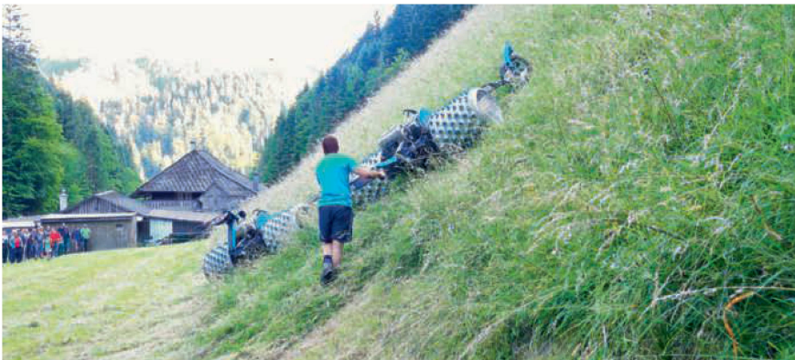
Même cette «Duo 6» de 6 m se laisse aisément piloter dans les talus.
