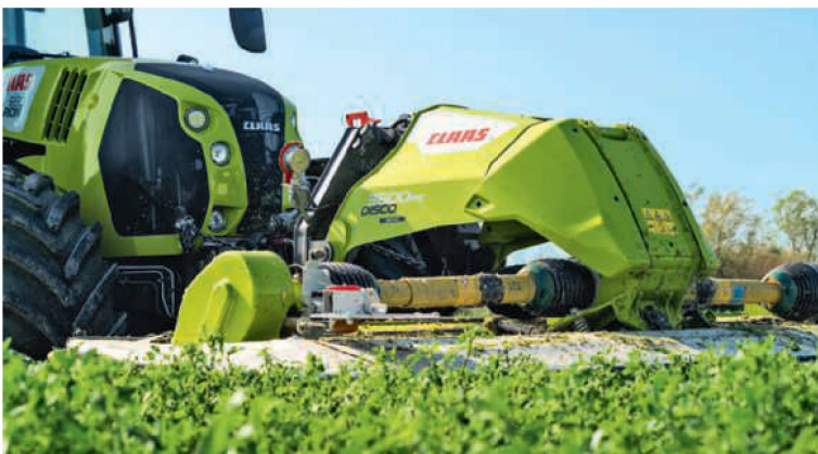
Pour les faucheuses frontales portées, il faut tenir compte du porte-à-faux avant, de la charge par essieu et de la capacité de charge des pneus. Attention à ne pas dépasser le poids autorisé avec les modèles lourds (surtout s'ils sont combinés à un conditionneur).
