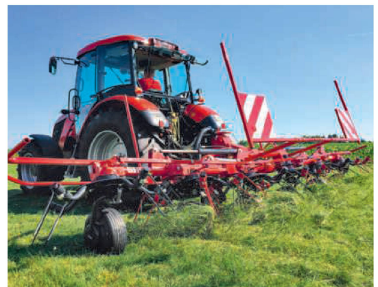
Un ramassage propre et intégral du fourrage dépend aussi du réglage correct de l'angle, de la hauteur et de la distance de projection. Un angle plus aigu est conseillé pour un fourrage lourd.
