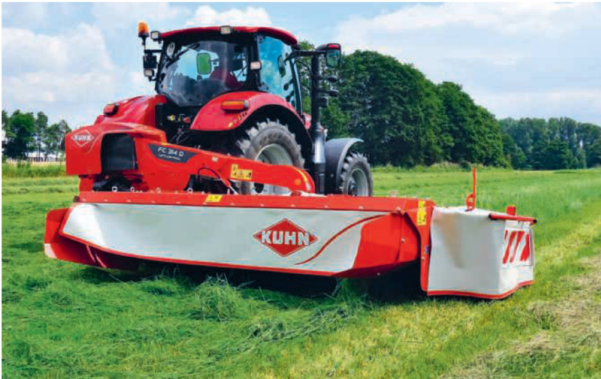
Les faucheuses rotatives se sont imposées aujourd'hui, attelées à l'avant ou à l'arrière du tracteur, ou encore utilisées en combinaison.
