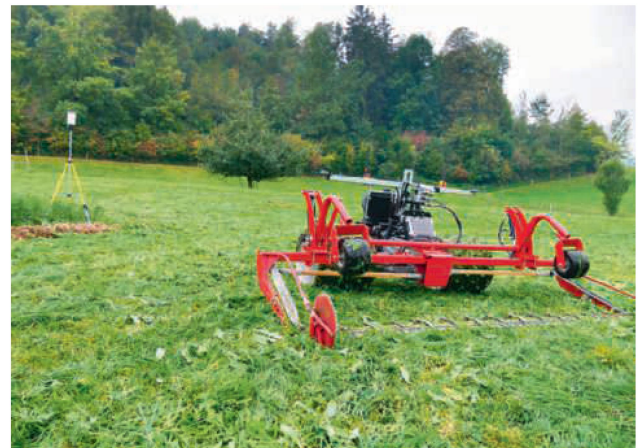
La motofaucheuse classique, ici partiellement autonome et équipée d'un peigne large à double couteaux, pourrait également trouver plus d'acheteurs en plaine.
