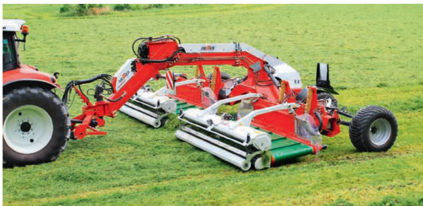
La nouvelle génération d'andaineurs à tapis fait appel à une technologie sophistiquée. Des toupies plus larges permettent de former des andains comportant bien moins de fourrage souillé, mais ils sont également beaucoup plus chers.
