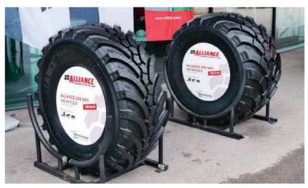
Le pneu «398 MPT» peut équiper des poids lourds agricoles roulant jusqu'à 100 km/h sur la route. Il est possible de réduire la pression à 0,8 bar pour les travaux des champs. Photos: Heinz Röthlisberger
