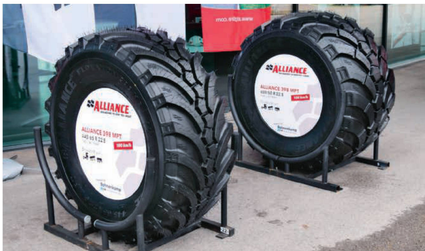
Le pneu «398 MPT» peut équiper des poids lourds agricoles roulant jusqu'à 100 km/h sur la route. Il est possible de réduire la pression à 0,8 bar pour les travaux des champs. Photos: Heinz Röthlisberger
