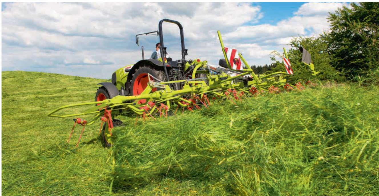
L'utilisation d'un arceau anti-retournement repliable est strictement encadrée par la législation et exige une autorisation cantonale. Photo: Claas
