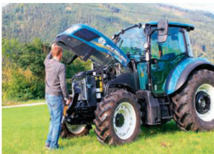
Les FPT 4-cylindres (Lindner, New Holland, MF) sont tous munis d'un EGR, d'un catalyseur DOC et d'un filtre à particules.
