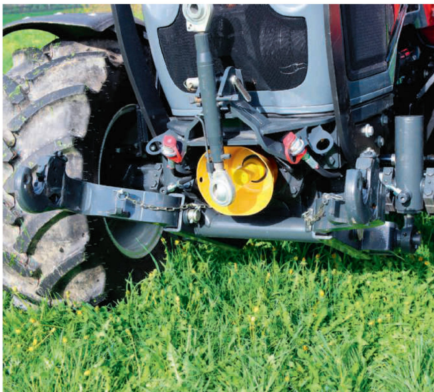
Le Lindner «Geotrac» a marqué des points lors de la fauche et du broyage grâce à son dispositif électronique de délestage de l'outil sur le relevage frontal solidaire de l'essieu.
