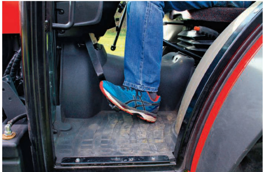
Le MF « 3708 WF » est le tracteur le plus compact du test. Il faut cependant accepter l'encombrement d'un tunnel de transmission sur le plancher de la cabine.
