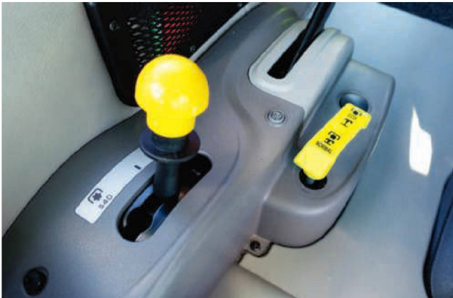
Seuls le Deutz-Fahr «5080G» (photo) et le Lindner «Geotrac 74ep» proposent quatre régimes de prise de force..
