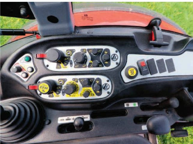
Lindner, comme trois autres candidats, offre une régulation électronique du relevage...
