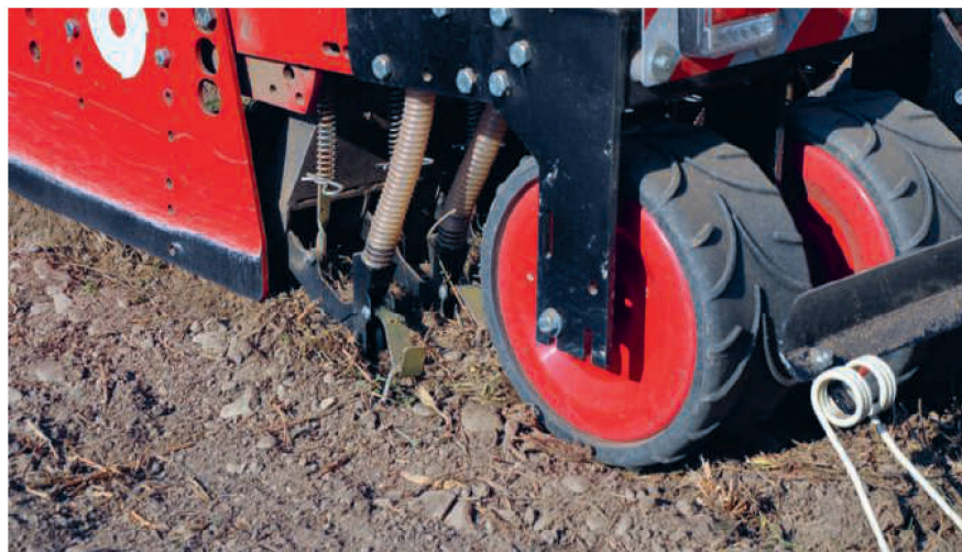
Les éléments de base d'un semoir sont un soc à lames, un rouleau Pneupacker et une herse.
