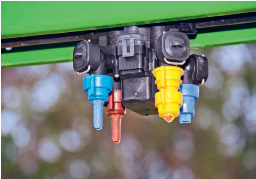
Plus le système de buses est complexe, moins il doit y avoir d'impuretés dans la bouillie de traitement. Photo: Amazone
