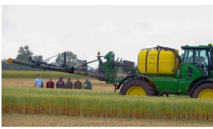
John Deere est pour l'instant l'unique constructeur à proposer une rampe ultralégère en fibre de carbone. La légèreté n'est cependant pas toujours un gage de stabilité.
