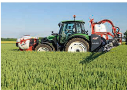
Kuhn est le seul constructeur à proposer un pulvérisateur à parallélogramme porté au trois-points.
