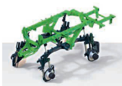
Sur l'automoteur Amazone « Pantera », les impacts sont fortement amortis par le train roulant tandem.
