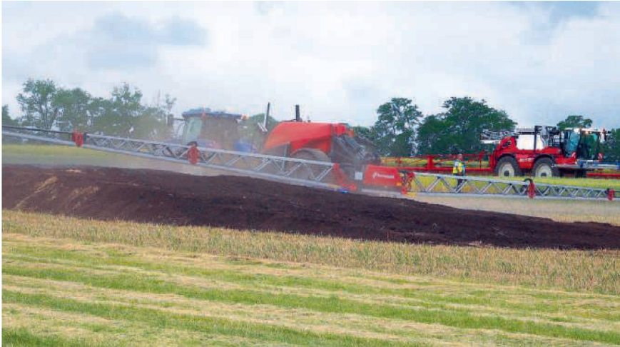
Dans la course sur les reliefs, le véhicule circule sur la partie plate du champ mais la barre doit « survoler » un monceau de terre aménagé à gauche du pulvérisateur.
