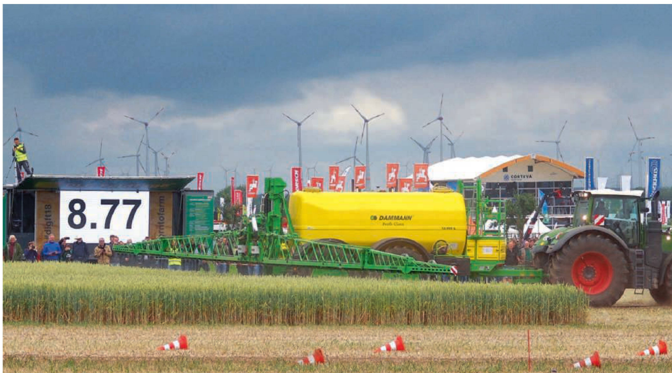
Aux journées de plein champ de la DLG, la mission est rude: les rampes doivent absorber des impacts, compenser des déclivités et des reliefs variés et, en plus, limiter ou empêcher les oscillations. Photos: Ruedi Burkhalter/ldd
