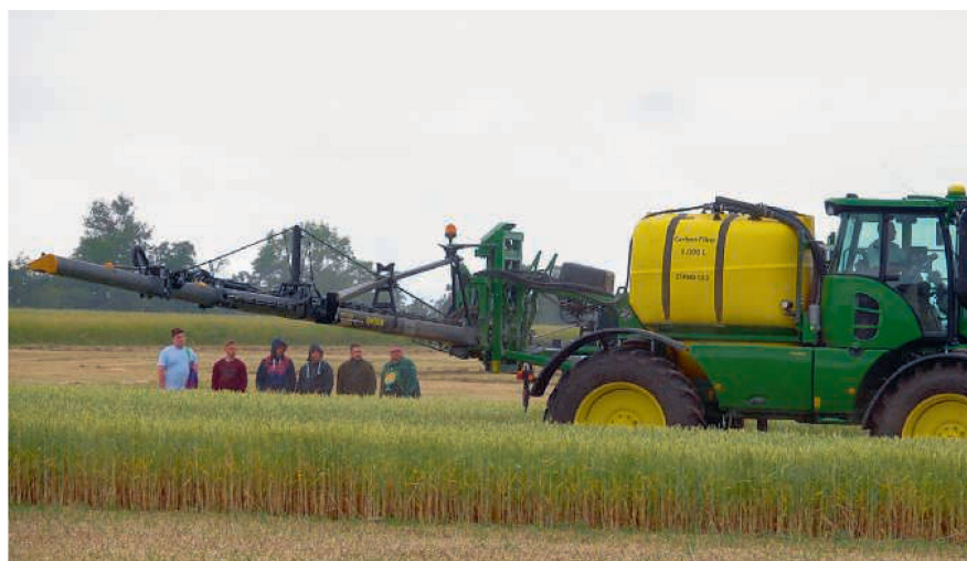
John Deere est pour l'instant l'unique constructeur à proposer une rampe ultralégère en fibre de carbone. La légèreté n'est cependant pas toujours un gage de stabilité.
