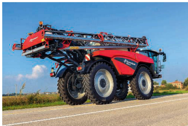
Les automoteurs comme l'« iXdrive » ont des cuves entre 4000 et 6000 litres, pour des largeurs de travail jusqu'à 40 mètres. Photo : Kverneland
