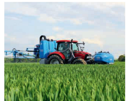
La cuve supplémentaire à l'avant permet d'augmenter le rendement à la surface de la machine. Photo : Lemken
