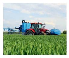
La cuve supplémentaire à l'avant permet d'augmenter le rendement à la surface de la machine, Photo: Lemken
