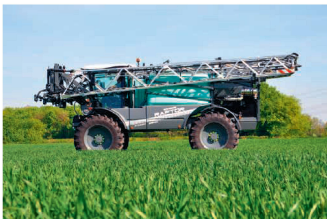
Tous les automoteurs ne sont pas construits sur le même principe. Celui-ci a une rampe de pulvérisation montée à l'avant. Photo : Berthoud
