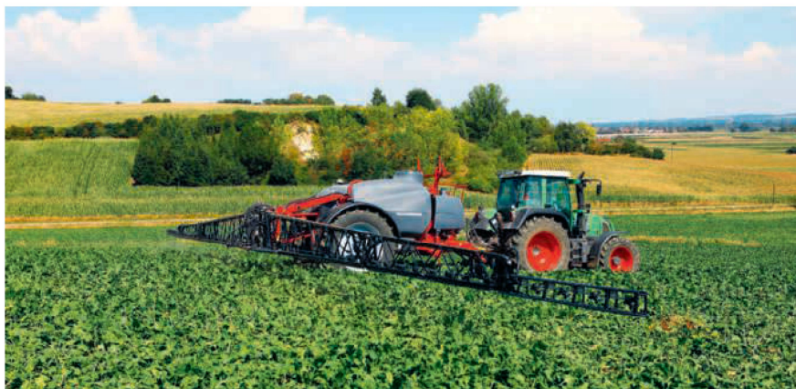
Le système de pilotage de rampe «BoomControl» maintient une distance constante entre les buses et la cible.
