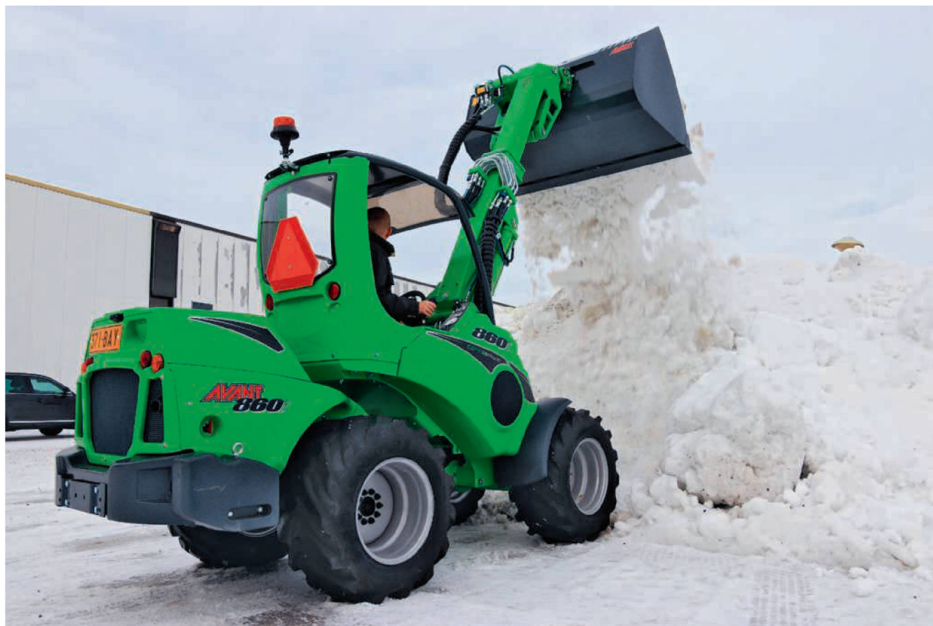
La nouvelle série «800» d'Avant affiche une capacité de levage de 1900 kg pour une hauteur de 3,5 m. Photos: Lukas Weninger
