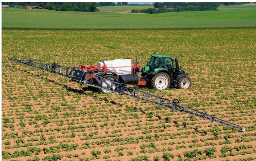
La rampe en aluminium se décline en largeurs de travail de 18 à 36 mètres.
