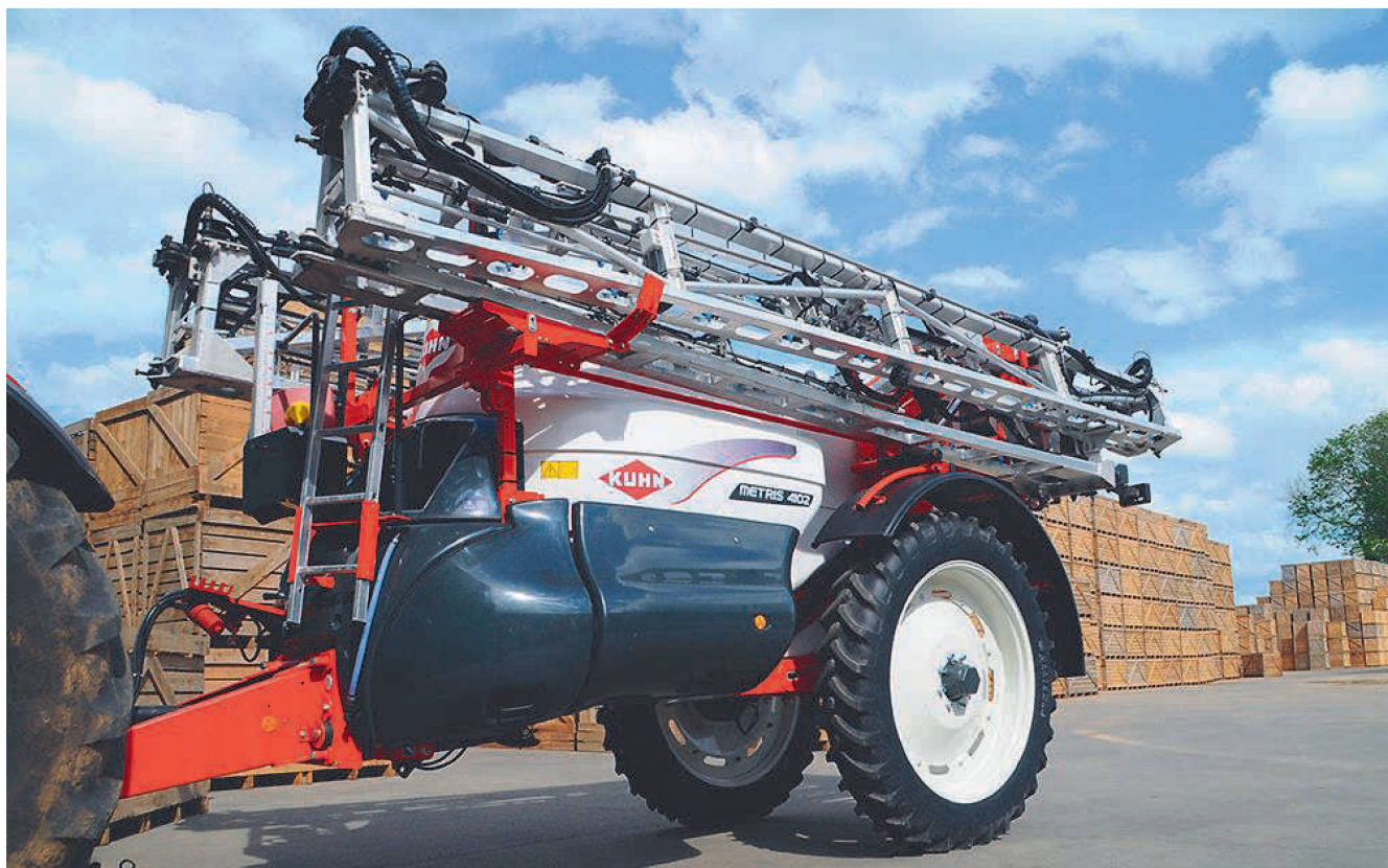
Le nouveau « Metris 2 » de Kuhn se distingue par sa grande précision d'application, reposant sur la modulation de la pulsation, et une construction compacte. Photos : Kuhn
