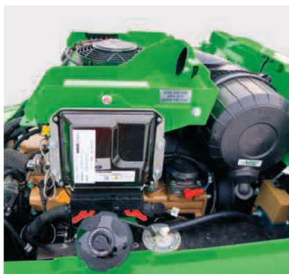
Le modèle haut de gamme « 860i » est doté d'un moteur Kohler d'une puissance de 57 ch satisfaisant à la norme antipollution Stage 5.
