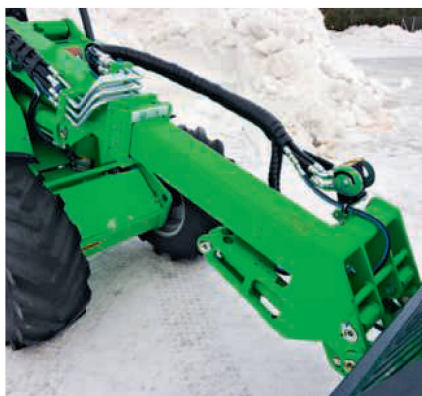
Le bras télescopique reposant sur deux (non plus un seul) vérins de basculement pour l'outil a des dimensions plus imposantes.
