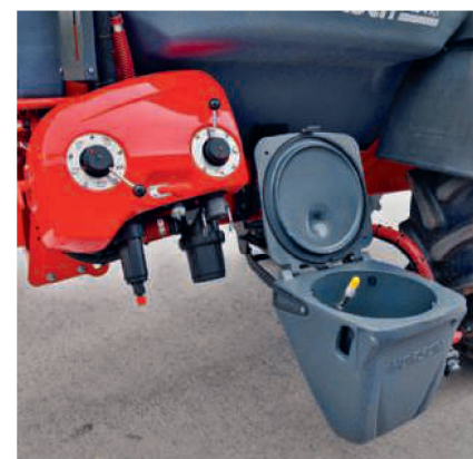
Incorporateur: deux vannes multi-voies suffisent pour commander le remplissage du «4 AX».
