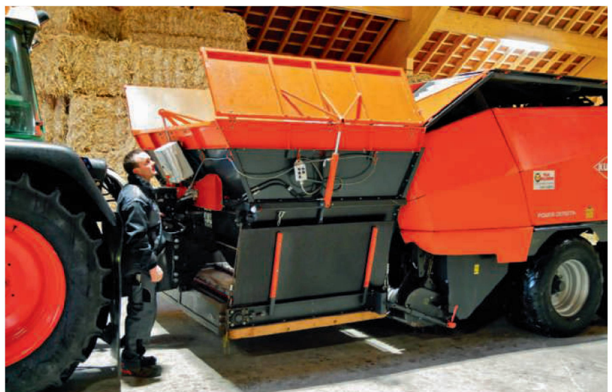
Prêt à presser en un rien de temps: Marcel Villiger positionne l'unité de dosage avec trémie ainsi que la glissière et ses parois latérales avec la commande hydraulique placée à l'avant de la presse.
