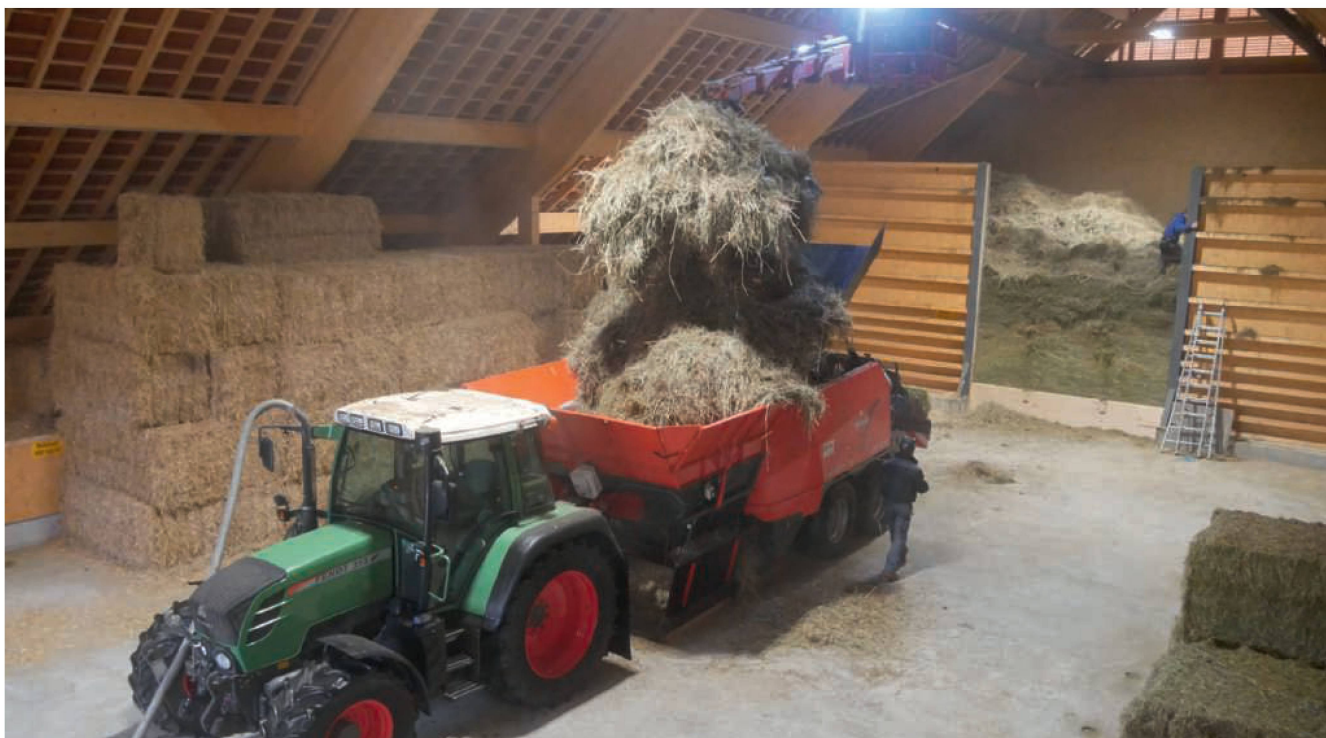
La presse à balles carrées Kuhn «LSB 1270» a été transformée pour presser du foin en grange dans le grenier du domaine Chamau. Un tuyau monté sur le tuyau d'échappement permet d'éviter les étincelles. Photos : Heinz Röthlisberger
