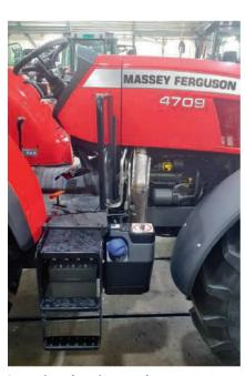
Le système de traitement des gaz «tout-enun» avec le réservoir d'AdBlue.
