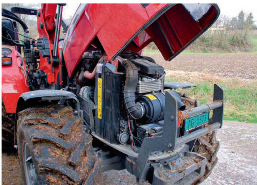
Les points d'entretien du moteur sont d'accès aisé. Le bloc de radiateurs est protégé des saletés par une grille amovible.
