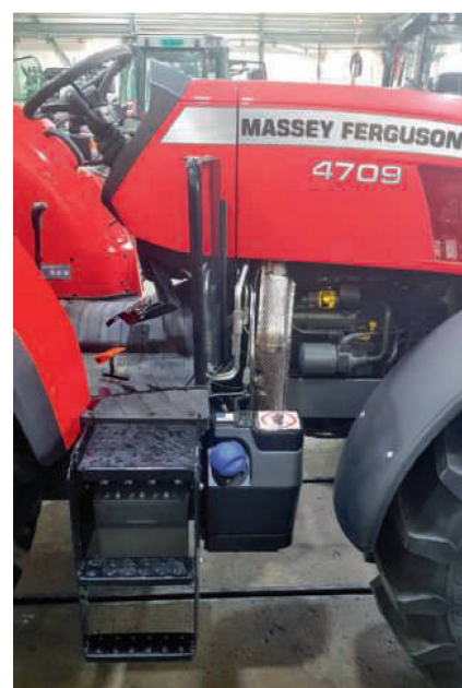
Le système de traitement des gaz « tout-en-un » avec le réservoir d'AdBlue.
