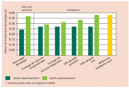
Les meilleurs résultats ont été obtenus sur les caillebotis avec le jet d'eau haute pression. Le système «rainurage-décapage» se situe au même niveau. Schéma: Rapport ARTn° 690
