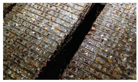
Développement d'une combinaison de décapage et de fraise diamantée pour les caillebotis. Les fentes endommagées, arêtes tranchantes et autres ébarbures sont inévitables et doivent être éliminées à l'aide d'une meuleuse d'angle.
