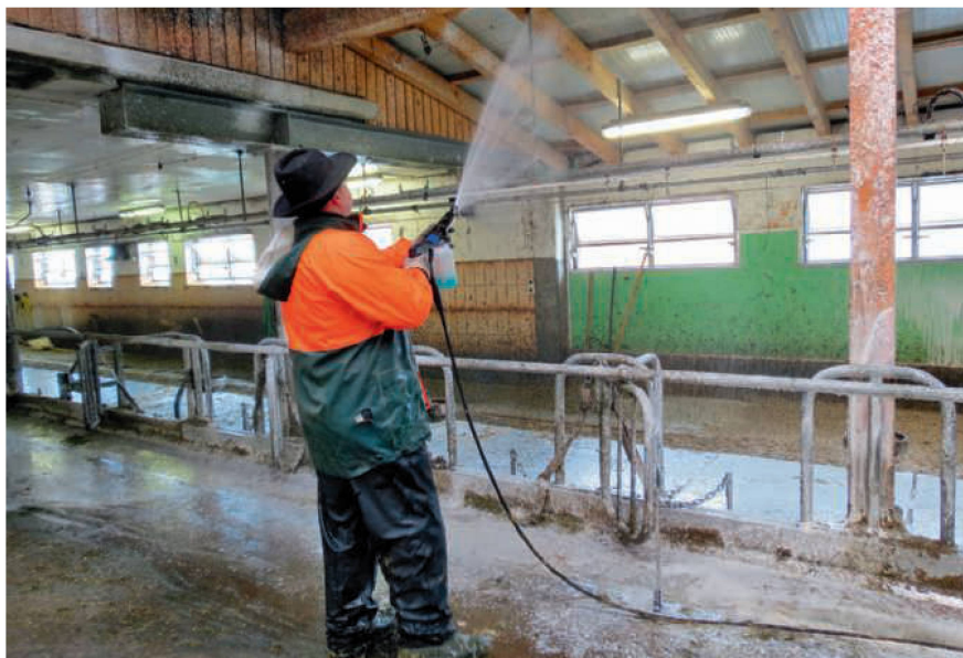
Des lances spéciales mélangent beaucoup d'air devant la tête de pulvérisation, ce qui produit une grande quantité de mousse.
