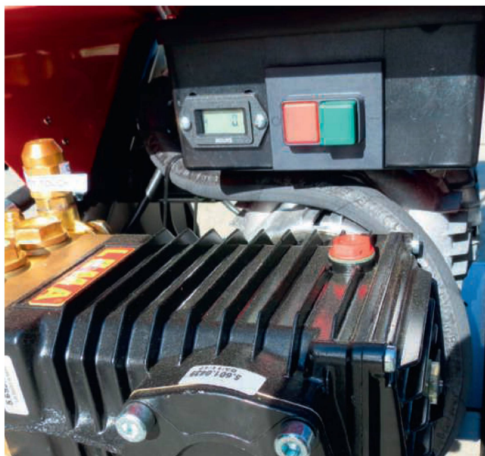
Le nettoyeur haute pression de Lema est le seul du test à disposer d'un compteur d'heures.
