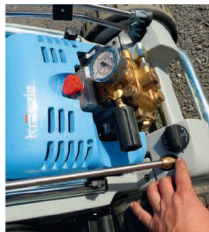
Un régulateur de pression se trouve sur la pompe montée à l'extérieur du carénage.
