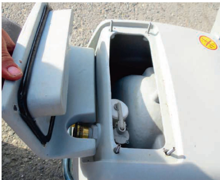
Le réservoir avec flotteur, d'une capacité de 16 l, se situe à l'arrière du châssis. Il permet de préserver la pompe.
