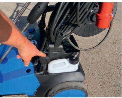
Deux réservoirs séparés et intégrés dans l'appareil sont disponibles pour l'adjonction de produits de nettoyage.
