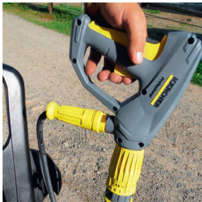
Le pistolet spécial «EasyForce» avec réglage de pression fait partie de l'équipement.
