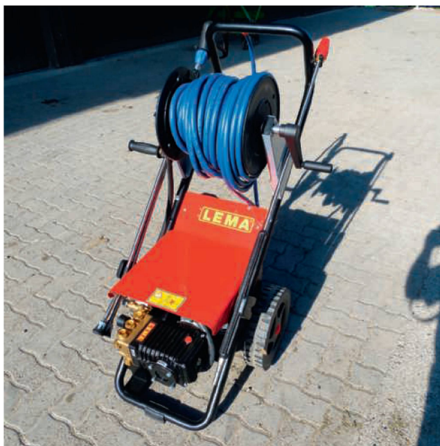
Le Lema «Red Power P21/200» est doté d'un robuste châssis tubulaire posé sur deux grandes roues.
