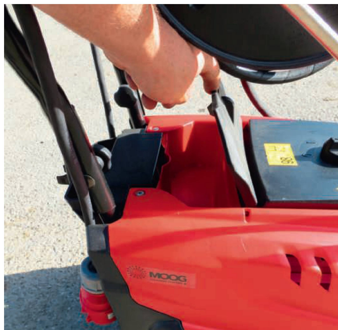
Les raccords du système d'accouplement rapide sont relativement petits, mais ont bien fonctionné lors de l'essai.
