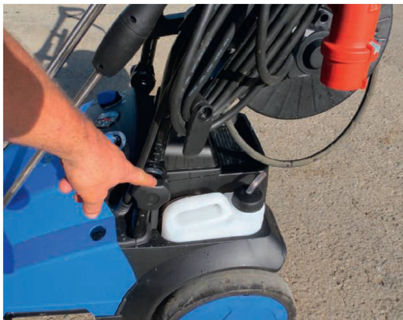
Deux réservoirs séparés et intégrés dans l'appareil sont disponibles pour l'adjonction de produits de nettoyage.
