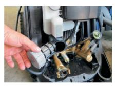
Un réservoir avec dispositif de réglage est disposé à l'arrière de l'appareil.
