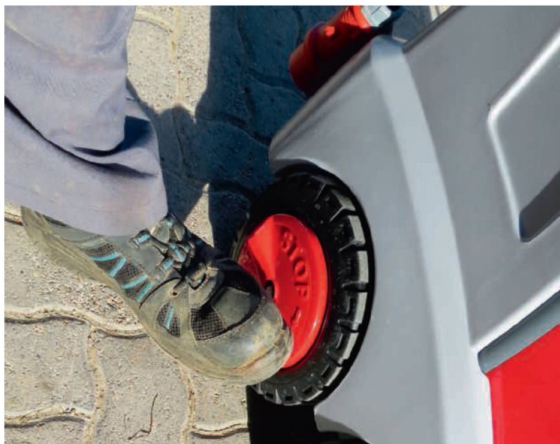
Un frein accessible et pratique est intégré de chaque côté sur l'essieu arrière du châssis tandem.
