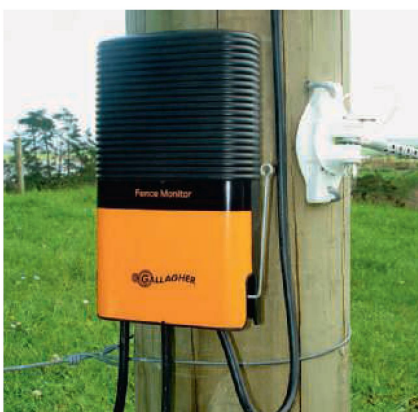
Pour surveiller des tronçons de barrières, six de ces «moniteurs de clôture» peuvent être reliés simultanément aux électrificateurs «i» de Gallagher.
