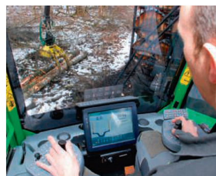
Une commande intelligente « IBC » et une balance à l'avant de la grue sont disponibles en option pour le porteur.
