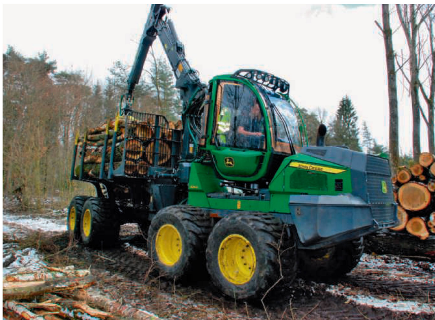
Le porteur « 1010G » de la nouvelle série G de John Deere avec 11 tonnes de charge utile a été présenté dans une forêt suisse pour la première fois à la fin janvier. Photos : Heinz Röthlisberger
