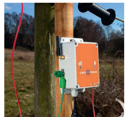
Autre système de surveillance externe, le «Luda.Fence» fonctionne avec tous les électrificateurs usuels. Il est proposé en deux versions, «Free» et «Alarm+».
