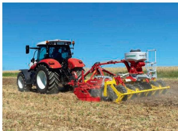
Pöttinger rend le système « Multiline » compatible avec le semoir à dérobées « Tegosem ». Il peut être utilisé en solo ou en lien avec le « Tegosem » pour la mise en place de cultures intermédiaires ou de dérobées destinées à être broyées. Dans ce deuxième cas, on utilisera un semoir mécanique « Vitasem »
