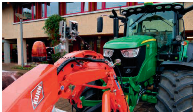
Le porte-à-faux avant peut atteindre 5 m si le véhicule est doté d'un système de caméra combiné à un feu de danger. Photo : Roman Engeler
