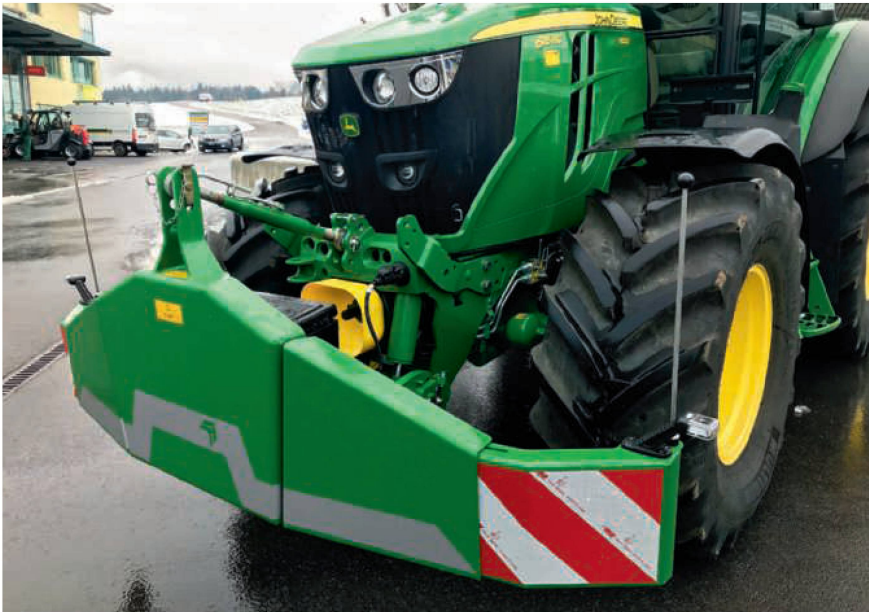
Marquage correct d'une remorque avec des pneus larges et une protection contre les collisions. Si la distance depuis le centre du volant dépasse 3 m, un rétroviseur en V est nécessaire. Photo: Wismer Landtechnik AG
