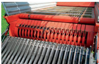
Des rails en Robalon assurent un fonctionnement silencieux du fond mouvant.
