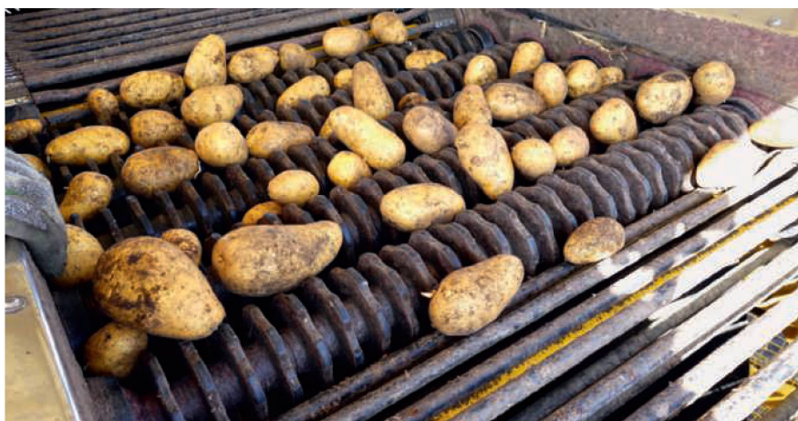
La table de visite est munie de cinq rouleaux calibreurs; elle offre un espace de travail confortable pour sept personnes.
