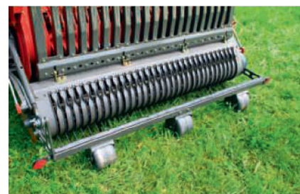
Large de 1,90 m et muni de cinq rangées de dents, le pick-up a un grand débattement.
