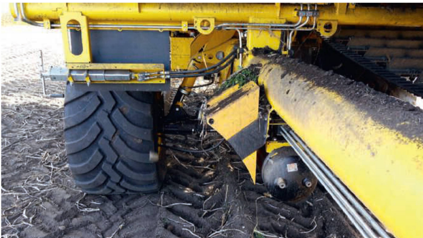
L'essieu est doté d'un dispositif de correction d'assiette hydraulique automatique relié au châssis tubulaire central.
