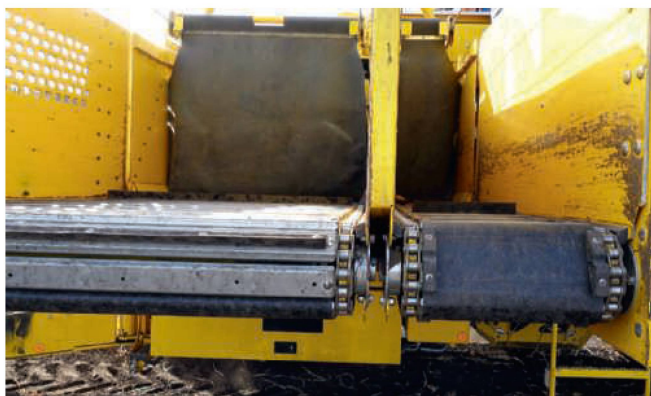
La trémie double offre une capacité de 6 tonnes, dont un quart réservé aux tubercules hors calibre.
