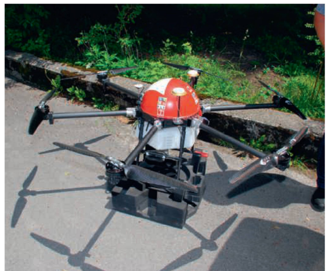
Ce drone pulvérisateur d'Agrofly a un poids total d'environ 40 kg et une charge utile de 17 kg. Photo : Heinz Röthlisberger
