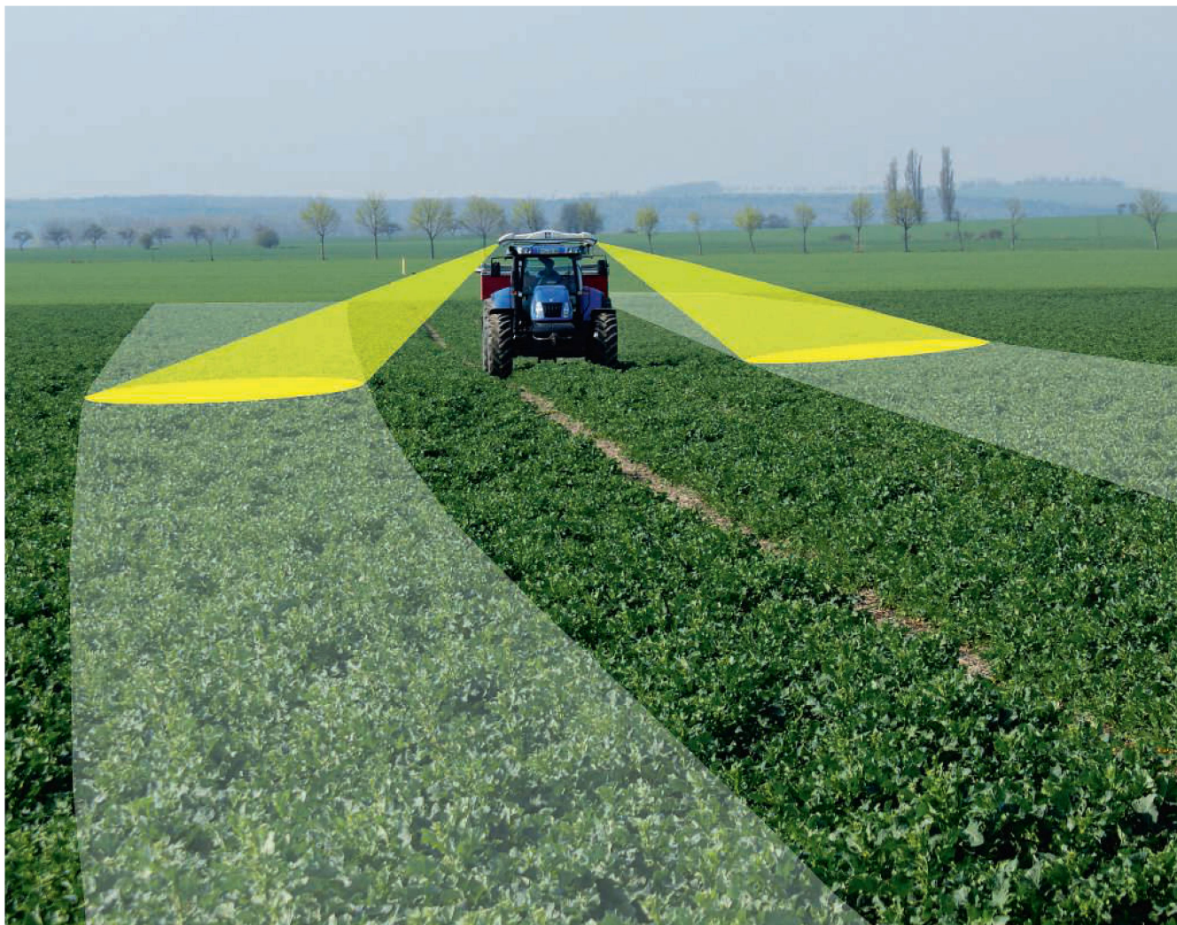
Installé sur le toit de la cabine, le Yara-N-Sensor «ALS» mesure et analyse la lumière solaire réfléchie par un couvert végétal. Photo: Yara
