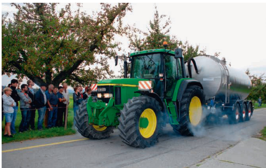
Sur les tracteurs, un système de frein à une conduite peut être installé en complément des systèmes à deux conduites (même au-delà de 2025, et ceci contrairement à ce que prévoit la réglementation européenne). Photos: Heinz Röthlisberger
