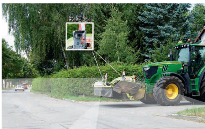
Si les outils portés avant sont équipés de caméras de vision latérale, le dépassement depuis le centre du volant est porté à 5 m. Photo: Fliegl
