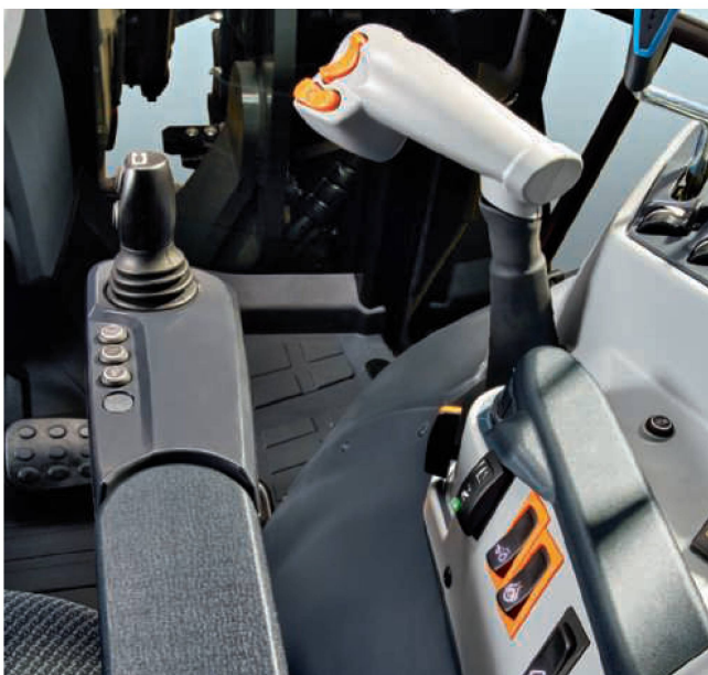
Les rapports sous charge et les groupes s'enclenchent grâce aux commutateurs à bascule sur le levier gris.
