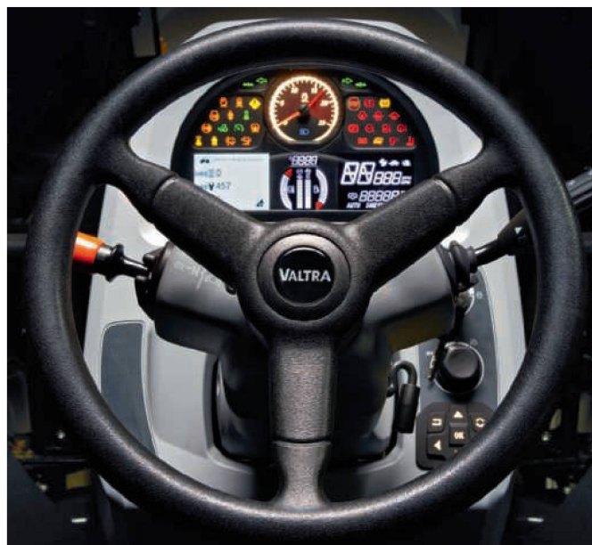
Les indications du tableau de bord peuvent être adaptées pour afficher les informations essentielles utilisées.
