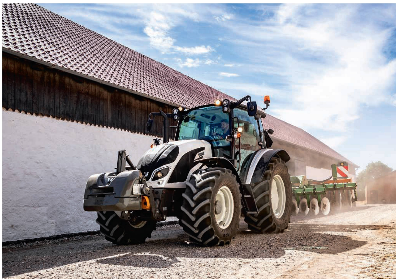
Valtra propose deux modèles de sa série «A» avec une transmission automatisée à quatre groupes de quatre rapports sous charge. Photos: ldd
