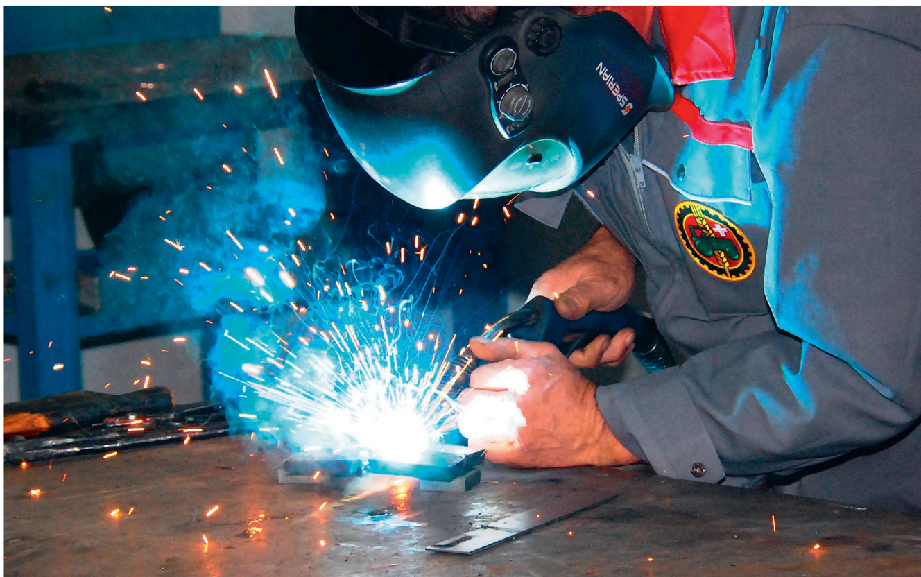
Souder (presque) comme un « pro »: Florian Schneller, responsable du cours à Riniken en train de réaliser un soudage MAG. Photos: Dominik Senn
