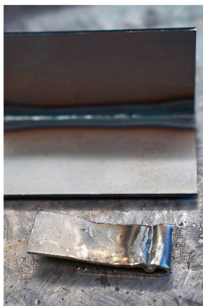
Le test du pliage a parlé, le cordon de soudure a tenu.
