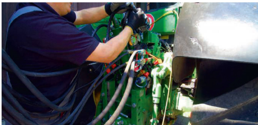
Il vaut mieux choisir des freins pneumatiques lors de l'acquisition d'un système à double conduite. Photo: Roman Engeler
