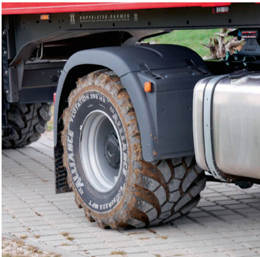
Les pneus «MPT» (acronyme du terme anglais multi-purpose tyres) conviennent à la fois aux déplacements routiers à vie allure et aux travaux dans le terrain. Photo : Heinz Röthlisberger
