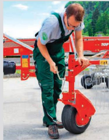
Commencer par régler la hauteur des roues, puis ajuster la hauteur totale de la toupie avec la manivelle.
