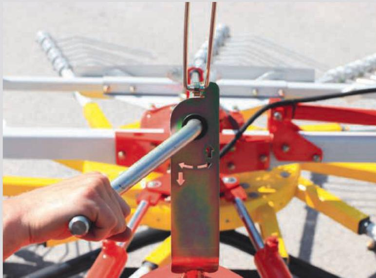
Une fois effectué le réglage de base au niveau de la roue d'appui: régler l'horizontalité de la toupie dans la direction d'avancement à l'aide d'une vis sans fin; ajustage fin de la hauteur pour tout le train de roues.
