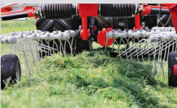
La largeur de l'andain doit être adaptée à la largeur de travail du pickup de la machine qui suit. Pour faciliter la reprise du fourrage, la section de l'andain doit avoir la forme d'un trapèze aux flancs raides. Si la raideur des flancs est insuffisante, le fourrage risque d'être écrasé par les roues du tracteur et ne pourra pas être ramassé par le pickup.
