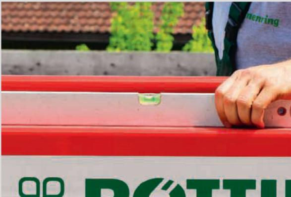
La principale différence par rapport à l'andaineur simple réside dans l'alignement du châssis: son horizontalité, ajustée à l'aide du dispositif de relevage du tracteur, doit être parfaite. Ce n'est qu'à ce prix que la cinématique des toupies pourra assurer un travail propre.
