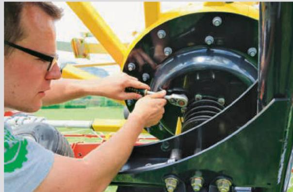
Une came réglable permet d'agir sur la forme de l'andain: si la raideur des flancs est insuffisante, il suffit de tourner la came pour amener les fourches à se désengager un peu plus tard, envoyant le fourrage un peu plus loin vers le centre de l'andain.
