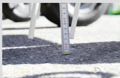
Réglage en hauteur des fourches: au point le plus bas, elles doivent garder une distance de 3 cm minimum par rapport au sol.
