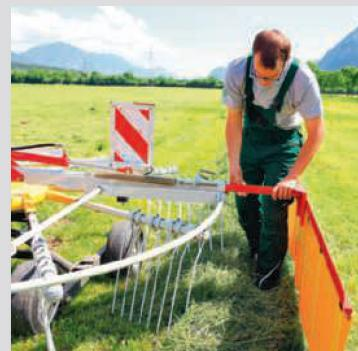
La toile d'andain est réglable en largeur, en hauteur et souvent aussi en longueur. La largeur de l'andain doit être adaptée à la quantité de fourrage et à la largeur du pickup de la machine de récolte qui suit.
