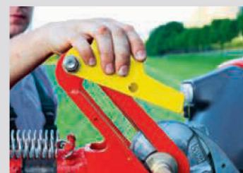
Pour le transport de la machine sur la route, le dispositif de suivi et le bras supérieur doivent être verrouillés, généralement en basculant des leviers ou en repositionnant des goupilles.
