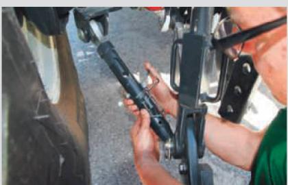
Tout comme la faucheuse, la faneuse exige que les bras inférieurs du dispositif de relevage soient fixes.
