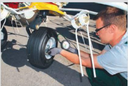
Contrôles avant de commencer: fixation des fourches, angle d'attaque, sécurité anti-perte et gonflage des pneus.
