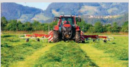
Adéquation entre la largeur de travail de la faneuse et celle de la faucheuse: en passant la faneuse il est important de ne pas rouler sur l'andain. L'épandage le plus régulier s'obtient par deux toupies tournant en sens opposé, qui reprennent le fourrage au milieu de l'andain. Photos: Johannes Paar et Lukas Weninger
