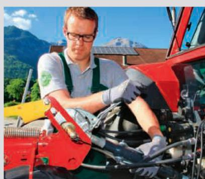
La longueur du bras supérieur doit être telle que la faneuse puisse se déplacer librement vers le haut ou vers le bas, ce qui est le cas au milieu du trou oblong. Si la faneuse est dépourvue d'une roue de jauge, la hauteur se règle en agissant sur la longueur du bras supérieur, qui est alors fixé dans un trou rond.
