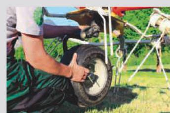
Réglage de l'angle d'attaque en agissant sur les roues pour optimiser le profil de dispersion en fonction de la quantité de fourrage et du degré de dessiccation. Corriger la profondeur de travail si nécessaire.
