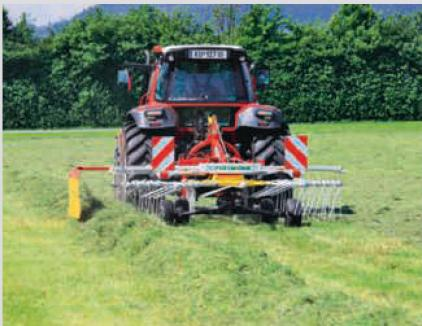
Ainsi que pour la faneuse, le régime de rotation et la vitesse d'avancement de l'andaineur doivent être choisis avec soin. La largeur et la forme de l'andain déterminent largement les performances des machines de récolte intervenant en aval. L'andain doit être aussi rectiligne que possible, évitant les virages serrés pour tenir compte des possibilités de braquage des machines qui suivent.
