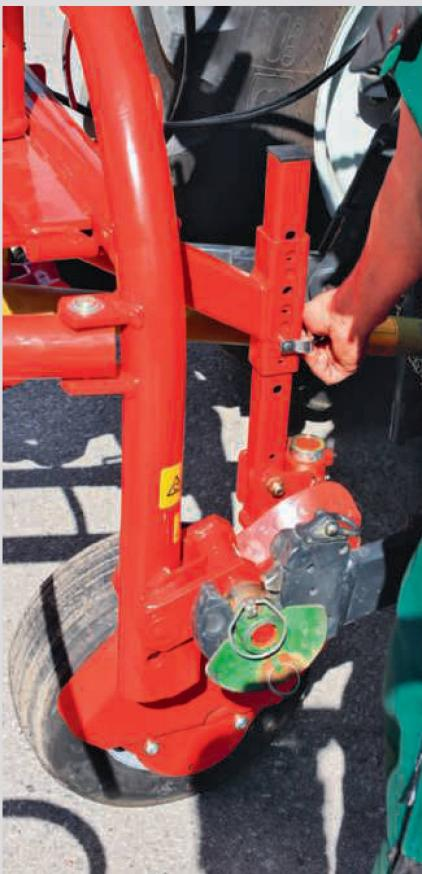
Comme pour la faneuse, la hauteur de la roue de jauge doit être réglée sur un sol solide: contrôle de la hauteur des fourches à l'avant, au niveau de la roue d'appui.
