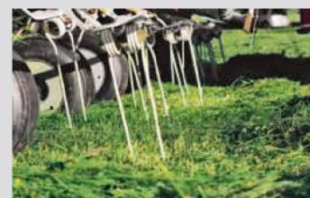
Au champ, il convient de reconstrôler la hauteur de travail en tenant compte de la hauteur des chaumes après la fauche. Procédure préconisée: avancer de quelques mètres pour permettre au châssis, une fois déployé, de se positionner; puis contrôler la hauteur des fourches. Les fourches ne doivent en aucun cas gratter le sol.
