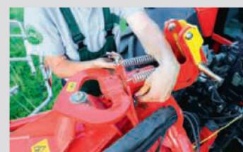
Dispositif de suivi: de nombreuses faneuses portées en sont équipées. Ce dispositif doit être déverrouillé pour passer de la position de transport à la position de travail.
