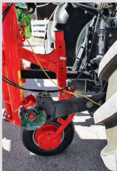
Si la faneuse possède une roue d'appui, la hauteur des fourches se règle via la roue de jauge au niveau du mécanisme d'attelage. Dans ce cas, le bras supérieur nécessite une certaine liberté de débattement. Le réglage doit être effectué sur un sol plat.
