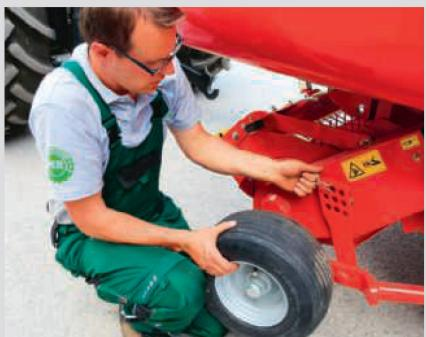
La hauteur par rapport au sol se règle à l'aide des roues de jauge de part et d'autre du pickup, parfois aussi à l'arrière: sur un sol solide, l'extrémité des dents doit se trouver à environ 3 cm du sol.
