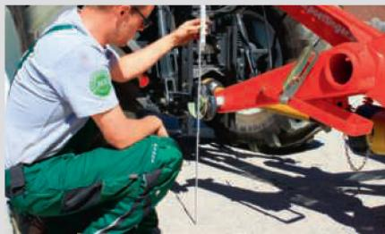
Au moment du levage et de l'abaissement de la barre de coupe, la suspension et la cinématique ne fonctionnent que si la hauteur de relevage est bien réglée. Tenir compte des indications du fabricant !
