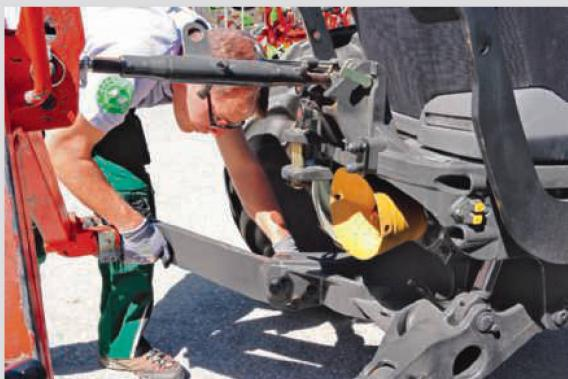
Selon qu'il s'agit d'une tête d'attelage frontale tirée ou poussée, les bras inférieurs doivent être fixés ou insérés dans le trou oblong. Tenir compte des indications du fabricant !
