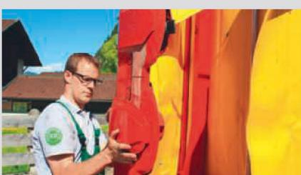
Pour une hauteur de fauche supérieure, il faut monter des patins de coupe haute, pour conserver l'angle d'attaque des lames. Sinon, on obtiendrait une coupe ondulée transversalement au sens de la marche. En outre, la surface de contact des patins se réduirait et l'usure augmenterait.
