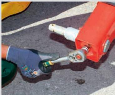
Le réglage latéral des axes des bras inférieurs permet de déterminer l'écart latéral par rapport aux roues et le chevauchement par rapport à la faucheuse frontale.
