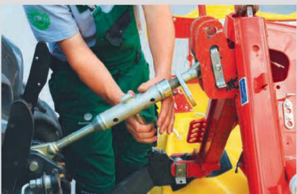
Le bras supérieur doit être réglé de sorte que les tambours soient horizontaux. Dans le cas d'une faucheuse à tambour, on ne règle pas la hauteur de coupe via le bras supérieur. Cela entraînerait une coupe ondulée.
