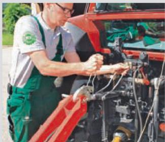
La longueur du bras supérieur est ajustée de sorte que la faucheuse repose le plus horizontalement possible sur le sol.
