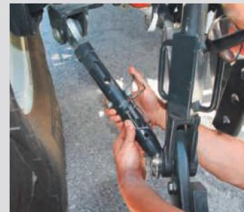
Les bras inférieurs du relevage arrière du tracteur doivent être bien centrés avec les stabilisateurs latéraux et ensuite fixés de manière adéquate.
