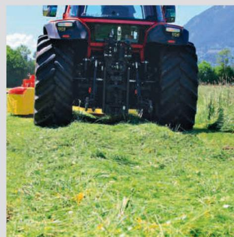
Si les roues du tracteur passent sur l'herbe coupée, les machines qui suivent ne peuvent plus la récupérer dans un état propre. Un réglage trop bas de ces machines occasionne aussi, et inévitablement, un fourrage contenant plus de souillures.
