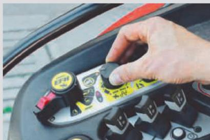
Un délestage électronique du relevage permet d'adapter la pression de contact de la barre de coupe aux conditions environnantes pendant la course. Un manque de poids sur la barre entraîne une coupe ondulée dans le sens longitudinal.
