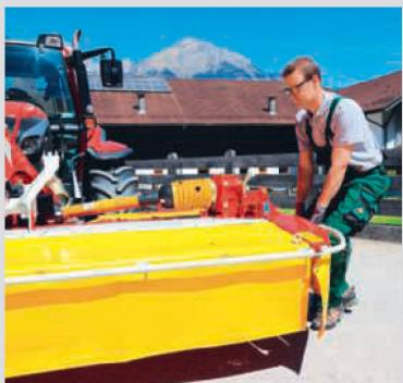
Tester le système de décharge en soulevant la barre de coupe d'un seul côté.
