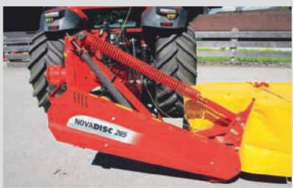
Une fois le réglage du levage terminé, on peut ajuster la suspension de la barre de coupe avec un ressort. Tenir compte des indications du fabricant !
