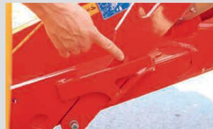
Généralement, les indications de hauteur de relevage se trouvent dans le mode d'emploi ou directement sur la faucheuse. Les marquages, dont un exemple est représenté sur la photo ci-dessus, servent au contrôle.
