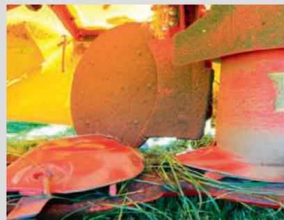
Des tôles d'andains ou des disques à andain rotatifs (le plus souvent disponibles en option) permettent de déposer le fourrage entre les roues.
