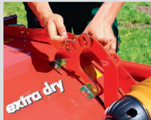
Resserrer progressivement le passage jusqu'à obtenir l'intensité de conditionnement souhaitée.
