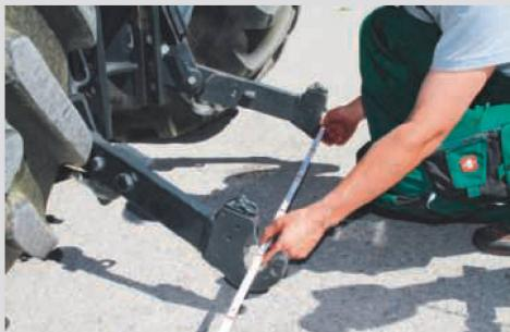
Avant d'atteler, il faut adapter l'écartement des bras inférieurs au type de tête d'attelage avec les stabilisateurs latéraux. On règle les deux bras inférieurs à la même hauteur avec des tiges de levage. Photos: Lukas Weninger
