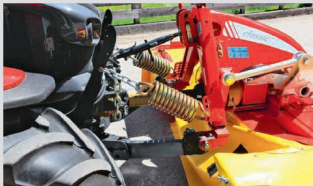
La tension et l'angle d'attaque du délestage à ressort influencent considérablement l'adaptation au sol. Suivre très exactement les indications du fabricant ! Une pression de contact réduite ménage la couche végétale.
