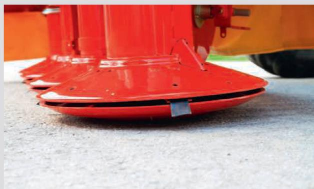
Pour une coupe plus haute, il faut augmenter l'écart entre le plateau de glissement et le tambour de coupe. Pour ce faire, les fabricants proposent des systèmes à broches, des plaques de distances ou des plateaux de glissement spéciaux.
