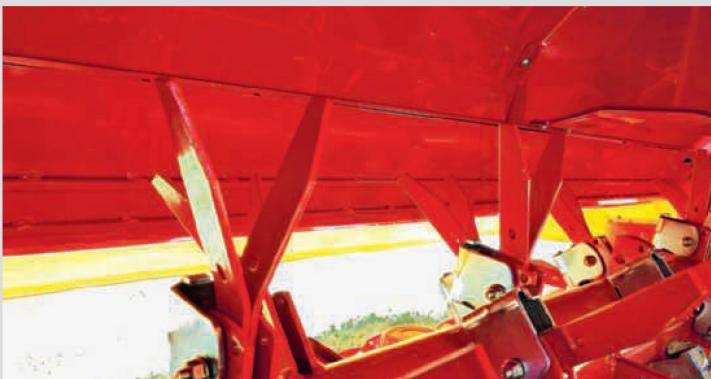
L'intensité du conditionneur se règle par la vitesse de rotation et/ou la largeur du passage. Attention avec le foin: un conditionnement trop intensif augmente la perte de fourrage!
