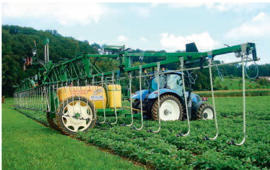
Les droplegs peuvent être montés comme équipements supplémentaires sur les rampes des pulvérisateurs conventionnels. Photos: Haller Lohnunternehmen et Birrhard
