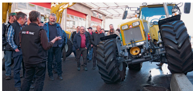
Marlis Knüsel indique les particularités du Rigitrac, entre autres l'articulation centrale et la transmission intégrale. Photo: Roman Engeler
