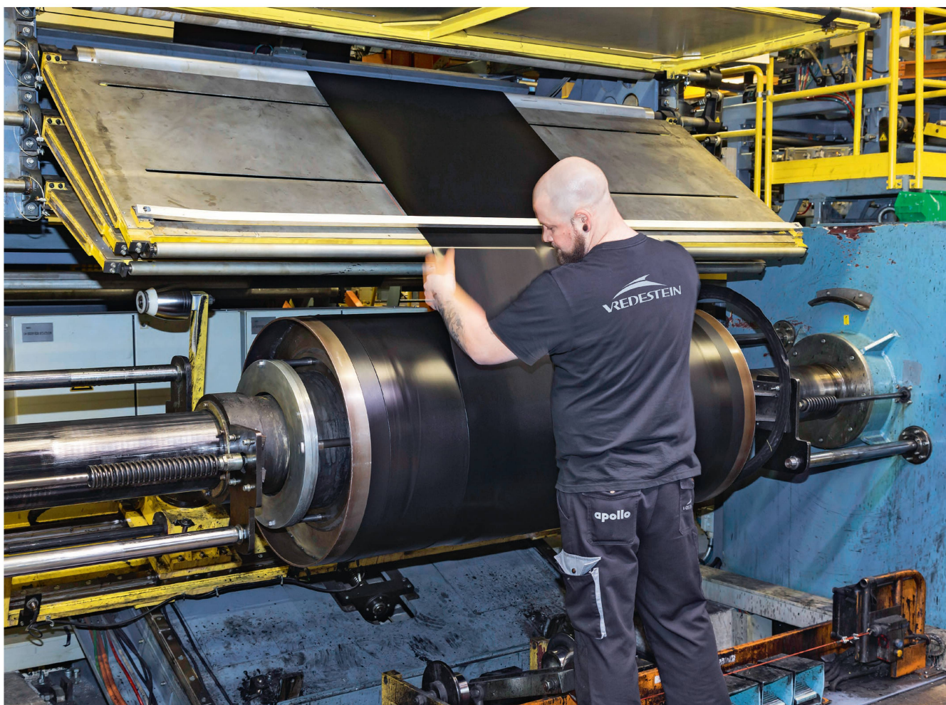
De nombreuses opérations se font encore manuellement dans l'usine Vredestein, à Enschede : les différentes nappes du pneu sont étendues une à une sur le tambour en rotation par les collaborateurs. Photos : Tovornik, Vredestein, et Dominik Senn
