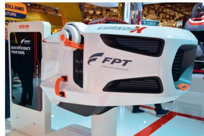
Par « Cursor X », le fabricant de moteurs FPT entend un concept d'entraînement puissant, modulaire, polyvalent et intelligent. Celui-ci convient à toutes les utilisations, qu'il s'agisse de gaz naturel, de piles à combustible ou de batteries. Grâce aux nombreuses possibilités de montage et d'installation, le « Cursor X » peut entraîner tous les types de véhicules utilitaires et de machines. De plus, ce nouvel entraînement dispose d'algorithmes d'auto-apprentissage.
