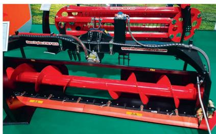
La firme BB Umwelttechnik est connue pour ses faucheuses doubles lames. Le constructeur bavarois a présenté pour la première fois la faucheuse frontale « Seco Duplex 275 F Eco » avec « andaineur hélicoïdal » boulonné en option. Le fourrage rassemblé entre les roues du tracteur peut ainsi être ramassé directement par l'autochargeuse.
