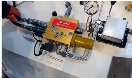
Paul Forrer a apporté des améliorations à son frein hydraulique à double conduite. La perte de pression dans la soupape de freinage d'urgence constatée appartient désormais au passé, grâce à un compresseur actif en permanence et garantissant la sécurité du système.
