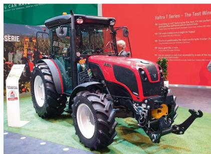
Valtra a présenté de nouveaux tracteurs viticoles et arboricoles. La série « F » compte quatre modèles avec des puissances allant de 75 à 105 chevaux. Le modèle standard mesure environ 1,5 mètre, le modèle à voie étroite 1,3 mètre de large seulement. L'équipement de série comprend une cabine chauffée et climatisée. Cette nouvelle série sera disponible à partir de début 2020. ■
