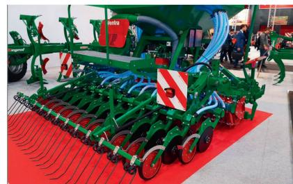
Regent a surpris avec son semoir pneumatique porté entièrement nouveau. Large de 3 mètres, le « Ventra » fonctionne avec 24 socs à double disque guidés par parallélogramme. Le système de dosage électrique est alimenté par une trémie de 820 ou 1100 litres. Le « Ventra » devrait arriver sur le marché dès 2021.
