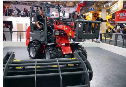
Malgré le dispositif de changement rapide, le conducteur doit généralement descendre du chargeur lors de l'attelage de l'outil afin de raccorder les éléments de commande hydrauliques. Weidemann a présenté son nouveau système « Easy Coupler ». Les raccords hydrauliques sont intégrés dans le système de verrouillage et se branchent automatiquement.
