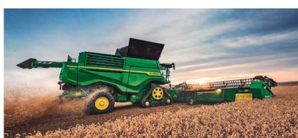
Selon John Deere, la nouvelle moisson-neuse-batteuse grande taille « X9 », avec dispositif de coupe en bande revisité, se place au-dessus de la série « S ». Cette aug-mentation de la productivité et de l'efficaci-té de la récolte provient du canal le plus large du marché, de l'amélioration du flux de récolte, du battage et de la séparation à double rotor et d'un crible plus grand.
