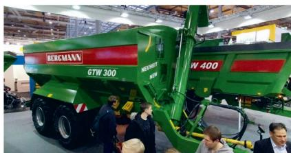
Bergmann a présenté une nouvelle génération de remorque de transvasement disponible en option avec compartiment divisé. Celui-ci est partagé perpendiculairement au sens de la marche en deux chambres avec un rapport de 50/50 ou 40/60. Une chambre peut être remplie de semences et l'autre d'engrais. Le doseur a également été divisé afin de pouvoir vider les chambres séparément.
