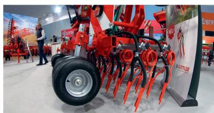
Avec « HarroFlex 600 », Gütter lance une nouvelle machine destinée à l'entretien et au sursemis des prairies. Les conduites de semences aboutissent directement derrière les dents de la herse. La semence est donc placée directement sur le sol et non plus sur l'herbage. Cette machine devrait être disponible à partir de mai 2020.
