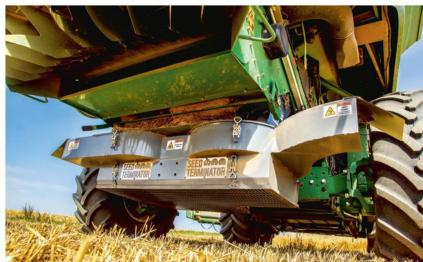
Zürn Harvesting a exposé le « Seed-Terminator ». Ses deux broyeurs à marteaux pul-vérisent les résidus du tamis de la moissonneuse-batteuse. Cela doit empêcher la ger-mination des grains perdus et des graines d'adventices. Le « Seed-Terminator » est dis-ponible pour les moissonneuses-batteuses John Deere, Claas, Case IH et New Holland. Une machine similaire de Redekop était présente au stand John Deere.
