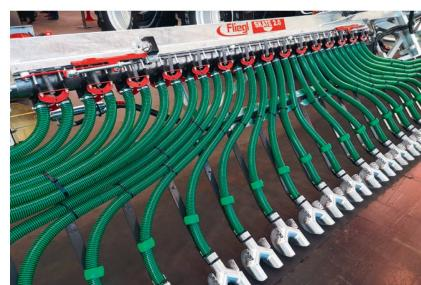
Fliegl a présenté à Hanovre son nouveau pendillard à sabot « Skid 2.0 ». En rabattant les segments extérieurs, la largeur de travail peut être réduite de 15 à 12 mètres. Le nouveau distributeur à vis « Flex-Flow » permettant des débits variables, ainsi que le sabot de distribution « Twin » en forme de Y, avec buses en deux parties, sont également disponibles sur demande.
