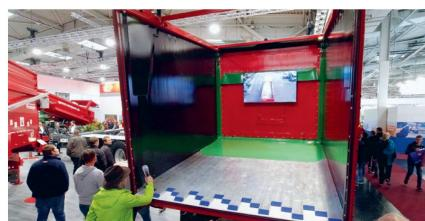
Avec sa semi-remorque à deux essieux « SKS 20/950 », Krampe combine les avantages d'une benne basculante avec le système de fond mobile. Sur terrain acci-denté, le conducteur peut déplacer pré-ablemment la charge en arrière grâce au fond mobile et lancer ensuite seulement le processus de basculement. La charge étant ainsi détachée, elle s'évacue plus fa-cilement lors du basculement. Le centre de gravité est également abaissé, ce qui améliore la stabilité à des vitesses de dé-chargement élevées.
