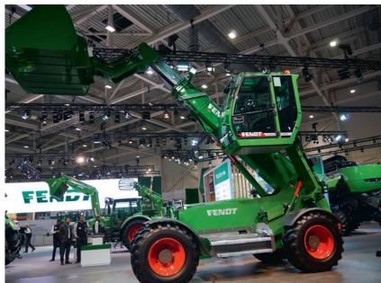
Fendt continue d'étendre son programme avec le chargeur télescopique « Cargo T955 », construit par Sennebogen, à Straubing en Basse-Bavière. Le Fendt « Cargo T955 » se distingue par sa cabine réglable avec amortisseur de vibrations. Avec une capacité de charge de 5,5 tonnes et une hauteur de levage de 8,5 mètres, il convient aux espaces de chargement les plus hauts.
