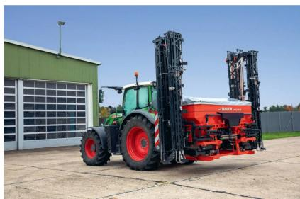
Rauch revoit la série « Aero » de ses épandeurs d'engrais pneumatiques. Technique-ment, ces machines diffèrent passable-ment des précédentes. Le système de dosage Multi-Rate, à commande électrique en option, permet de gérer individuelle-ment 24 tronçons de rampe de 1,25 mètre chacun. Le nouvel « Aero 32.1 » a une ca-pacité de 3200 litres d'engrais qu'il distri-bue sur 18 à 30 mètres de largeur.
