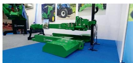
Les tracteurs doivent être aussi légers que possible pour le transport sur route et les travaux à la prise de force, mais doivent s'alourdir pour les travaux de remorquage lourds. Le montage de ballasts conventionnels, tels que les poids sur les roues, s'avère astreignant. John Deere et Laforge ont développé le concept « EZ Ballast ». Il s'agit d'un ballast de 1700 kilos qui se monte hydrauliquement sous le tracteur.
