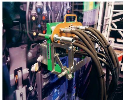
Avec son raccord multifonction « F-Con », Fliegl propose un raccordement rapide et surtout aisé des conduites hydrauliques et pneumatiques, ainsi que des câbles électriques entre le tracteur et la remorque. Il est ainsi possible de raccorder d'un coup les câbles de données et électriques, les tuyaux d'épandage d'engrais et de pro-ducts de nettoyage, les conduites de frein et jusqu'à douze raccords hydrauliques.
