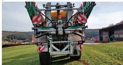
Les citerne à lisier à moitié pleines voient leur centre de gravité se déplacer considérablement dans les pentes. Pour assurer davantage de sécurité et de traction dans ces conditions, Zunhammer propose désormais une compensation automatique de pente et un essieu moteur pour les terrains difficiles. L'essieu à ressort hydraulique, à débattement particulièrement important, tend à maintenir autant que possible le véhicule en position horizontale, de manière analogue aux moissonneuses-batteuses.
