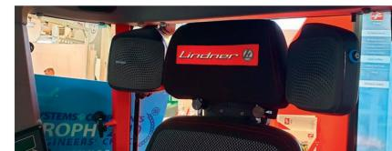
Recalm souhaite utiliser des ondes sonores actives pour réduire le bruit dans les cabines. En collaboration avec Lindner, la start-up hambourgeoise a présenté un système actif de réduction du bruit. L'émission d'ondes contraires ciblées depuis l'appuie-tête, par simple pression sur un bouton, doit réduire jusqu'à 75 % les bruits gênants et nuisibles pour le conducteur dans la plage de fréquence jusqu'à 500 Hz.
