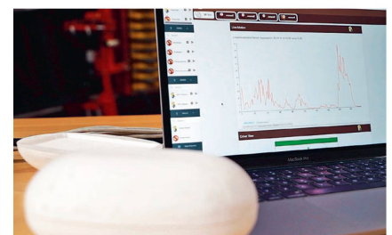
La « nPotato » : fermée au premier plan et ouverte en arrière-plan. On distingue sur l'ordinateur portable le profil de secousses qu'elle a enregistré.
