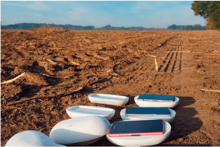
Grâce à des leurres en forme de pommes de terre et équipés d'un smartphone, les contraintes sont enregistrées et transmises en temps réel. Photos: projet « nPotato Smart Service »
