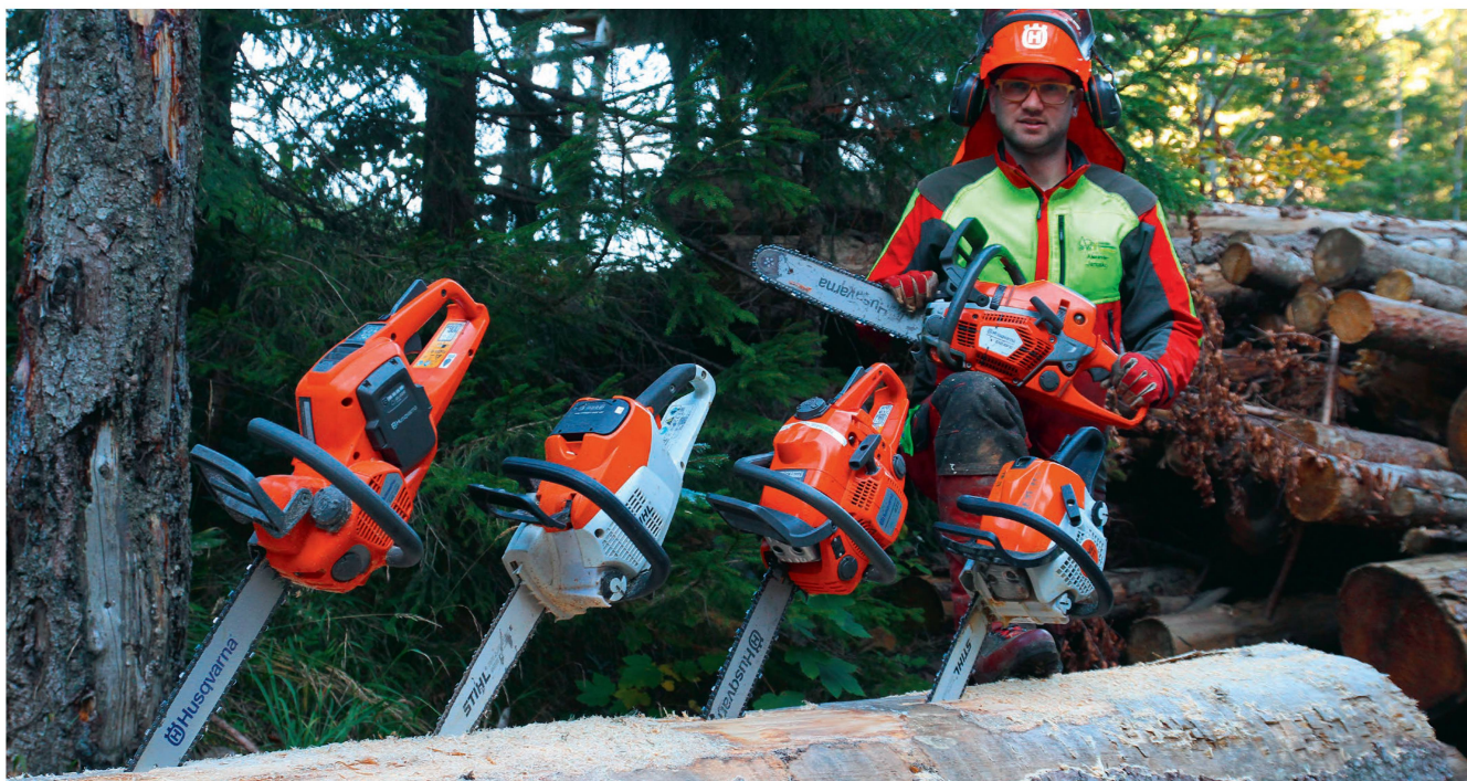
La Husqvarna « 536 LiXP » (à gauche) et la Stihl « MSA 200 C » (deuxième à partir de la gauche) ont été comparées avec des tronçonneuses à essence de différentes catégories de puissance lors d'un essai pratique. Photos : Johannes Paar et Wilhelm Tritscher
