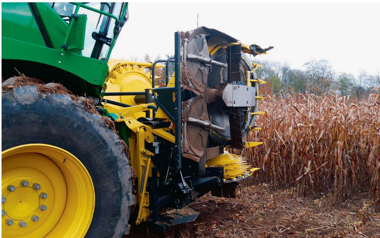
Le bec à maïs Kemper à huit rangs relevé dégage la vue sur les « StalkBuster ». Les broyeurs à fléau intégrés immédiatement derrière l'unité de coupe détruisent les chaumes de maïs avant qu'ils ne soient écrasés par les roues de l'ensileuse. Photos: Heinz Röthlisberger
