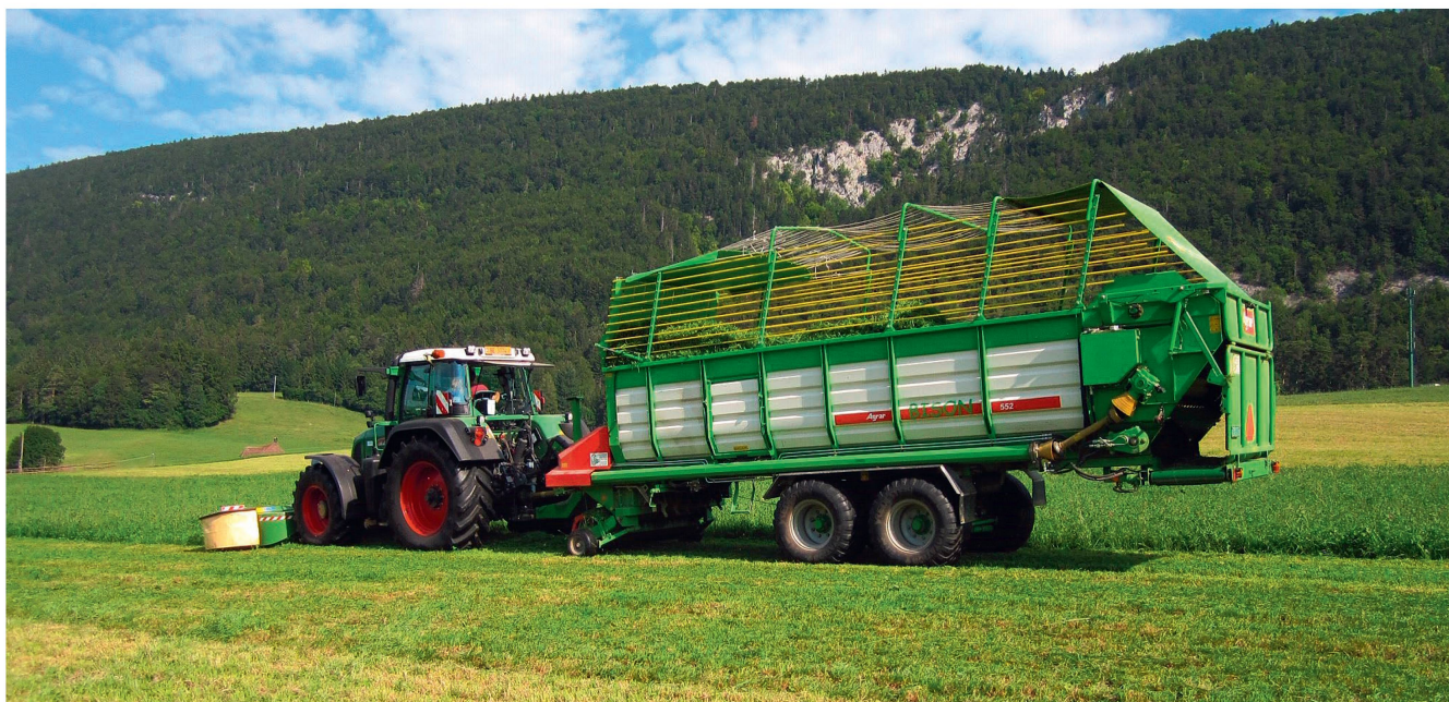
Une autochargeuse performante: avec sa « Bison 552 », Eric Brunnschweiler récolte le foin et l'herbe pour plus de 100 têtes de bétail. L'autochargeuse est équipée d'un essieu tandem, d'un doseur et d'un tapis roulant pour distribuer le fourrage. Photos: Idd
