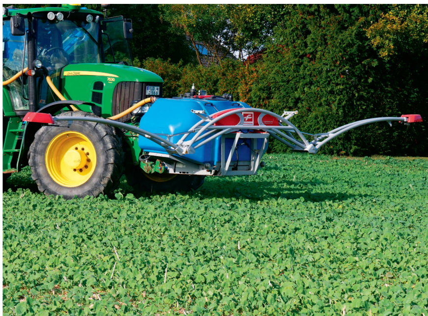
À chaque passage du tracteur, le capteur «Isaria» est toujours là pour scanner le peuplement et recueillir des informations permettant d'optimiser la cartographie.
