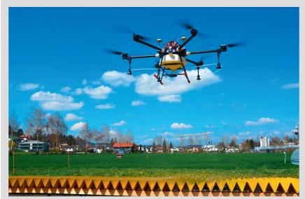
Un drone au banc d'essai pour tester la régularité de son pulvérisateur. Photo: Thomas Anken, Agroscope
