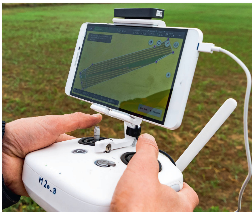
Sur l'écran de l'unité de commande, on peut voir le plan de vol prédéfini ainsi que la position actuelle du drone agricole.
