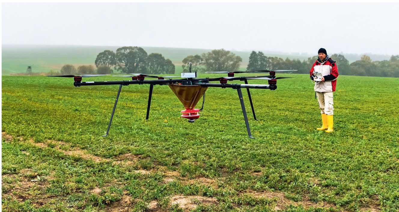
Le « Maja 20 » a un diamètre d'environ quatre mètres et un poids total de près de 50 kilos. Photos : Carmen Rudolph
