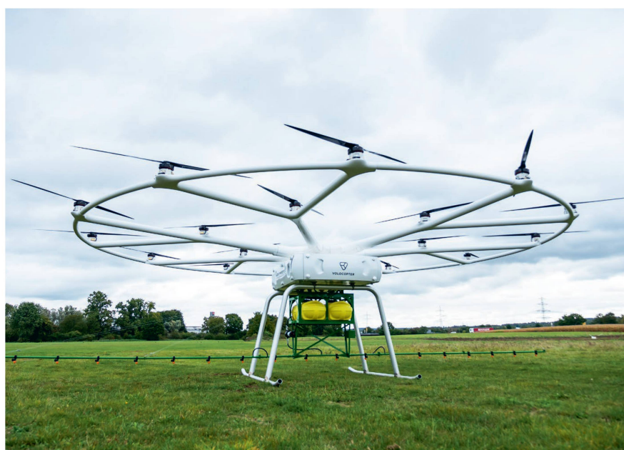
À l'Agrotechnica, John Deere et Volocopter ont présenté un grand drone de pulvérisation capable de transporter près de 200 kilos pendant une demi-heure. Photo : John Deere
