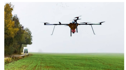
Le drone porteur du prestataire de service Agroflight à l'épandage de granulés de soufre sur une parcelle de céréales bio. La largeur de travail est de 9 mètres.
