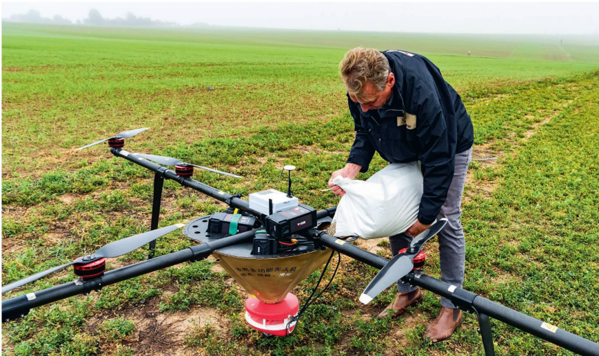
Voici le remplissage de la trémie conique du drone agricole avec 20 kilos de granulés de soufre. Le dispositif d'épandage est situé à la base du cône.
