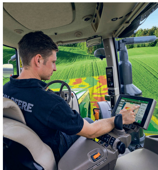
Le système «NBalance» développé par John Deere et Airbus permet de suivre le bilan azoté des grandes cultures et de l'évaluer après la récolte. Photo: John Deere
