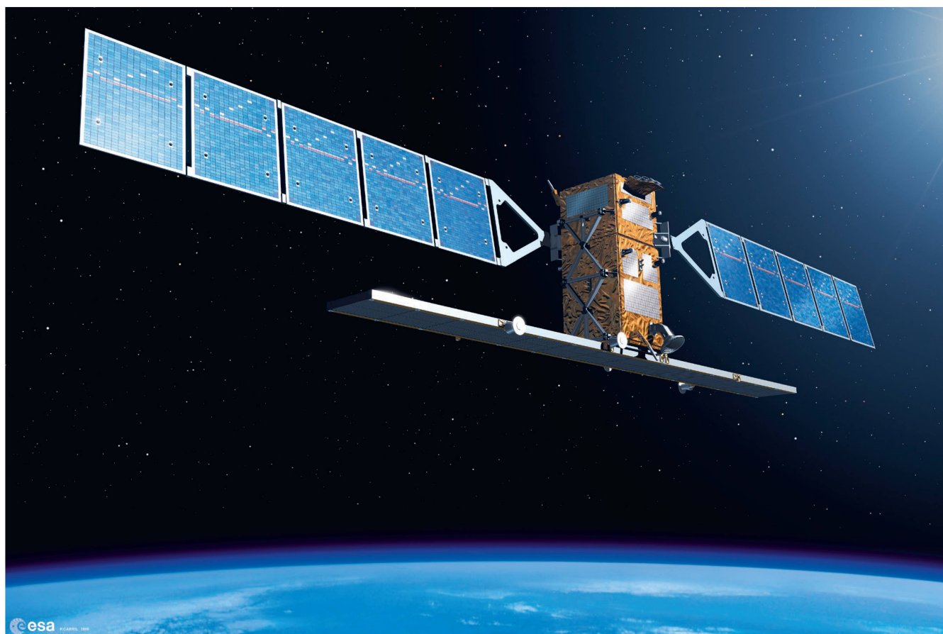
« Sentinel-1 » envoie des micro-ondes à la surface de la Terre et mesure la réflexion reçue. Cela permet de détecter les évolutions des terrains agricoles, par exemple à la suite du travail du sol, de la croissance des cultures ou de la récolte. Photo : ESA
