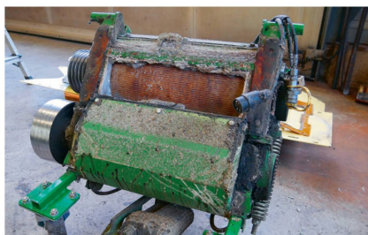
Voici à quoi ressemble un éclateur à grains après une saison de hachage.
