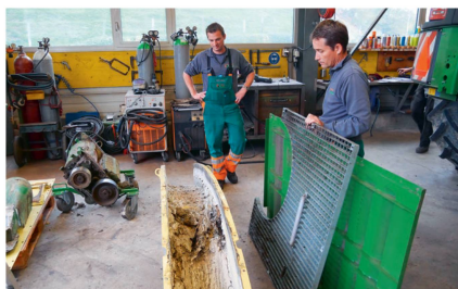
Le bec de sortie est plein de résidus de récoltes hachés.
