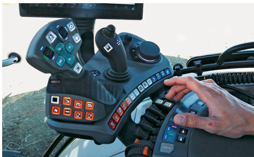
Un levier multifonctionnel, un joystick «3L» et un bouton-poussoir rotatif ainsi que de nombreuses touches : 45 fonctions peuvent être commandées depuis l'accoudoir repensé.
