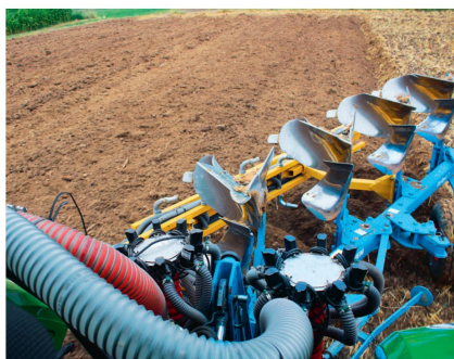
Lors du labour, les semences sont soufflées au travers de deux têtes de distribution, dans l'horizon supérieur du sol pour les graines fines et plus profondément pour les légumineuses.
