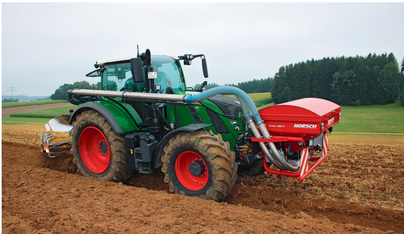
L'élément semeur monté sur la charrue avec trémie frontale associe le labour et le semis simultanés de cultures dérobées. Photos: Helmut Süß
