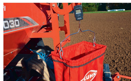
Une fois la distribution calibrée, la dose de semences peut être pesée directement sur la machine.
