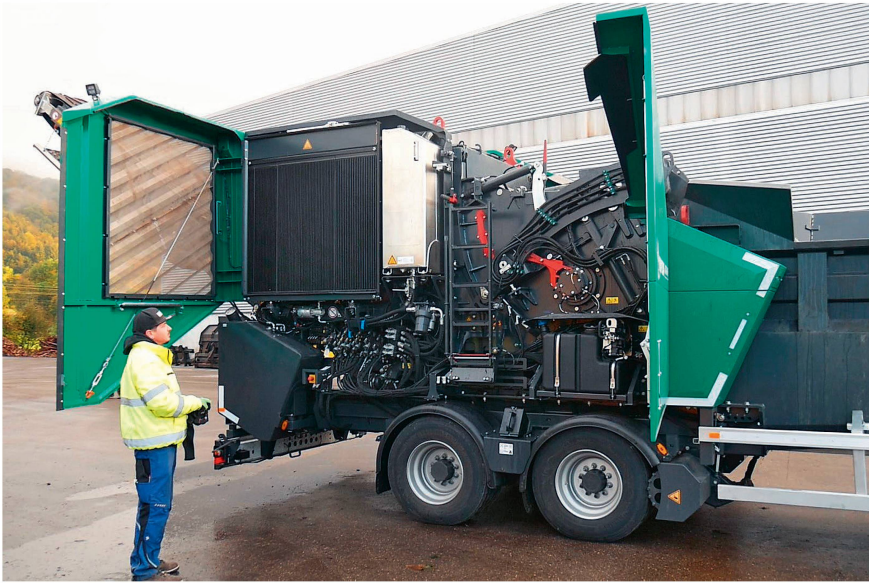
La machine est commandée à distance. L'enceinte du rotor, le crible et le tambour d'alimentation peuvent être ouverts par un dispositif électro-hydraulique.
