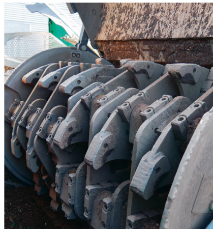
Le rotor peut être équipé de 32 outils oscillants pour le broyage ou de 32 outils fixes pour le déchiquetage.
