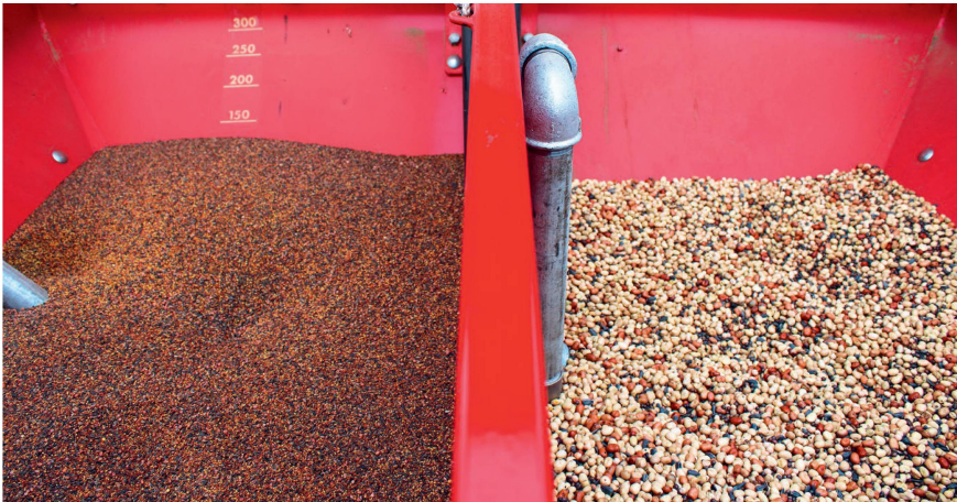
Grâce à la trémie frontale en deux parties, il est possible de semer séparément des graines fines et des légumineuses.
