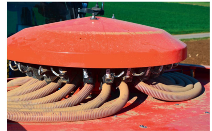
La tête de distribution comporte des clapets « Vistaflow » intelligents pour surveiller le flux de semences.
