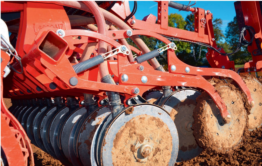
Les éléments semeurs « Seedflex » disposent de doubles disques décalés avec un décalage de 35 centimètres entre les rangées avant et arrière.
