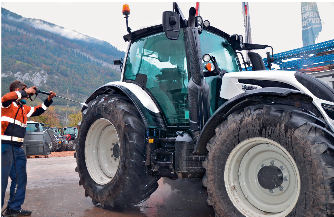
Le nettoyeur à haute pression sert à dégraisser les tracteurs, machines et équipements agricoles. Photo : Ruedi Hunger
