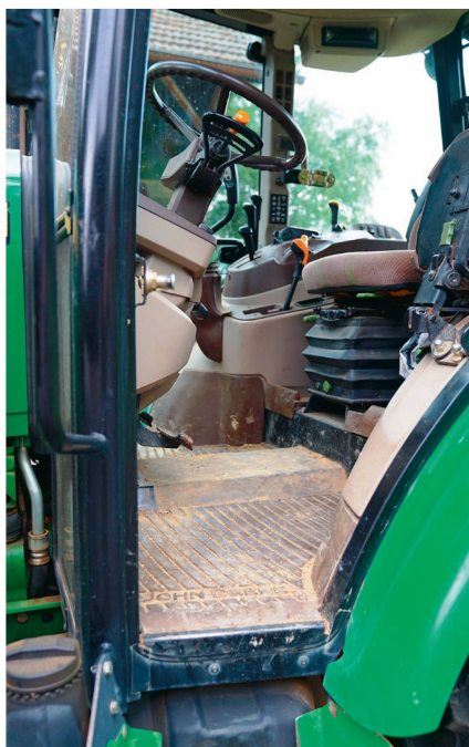
La cabine est abaissée mais aussi son plancher, jusqu'au canal central.
