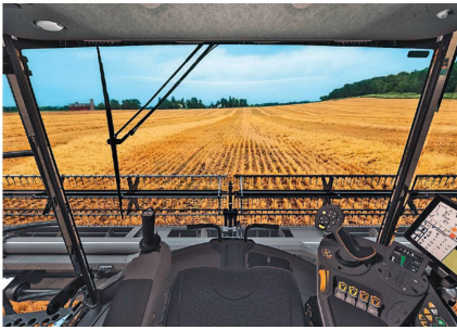
La moissonneuse-batteuse «Ideal» d'Agco offre un champ de vision dégagé à l'avant. Le volant et la colonne de commande sont remplacés par un joystick latéral.
