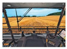
La moissonneuse-batteuse «Ideal» d'Agco offre un champ de vision dégagé à l'avant. Le volant et la colonne de commande sont remplacés par un joystick latéral.
