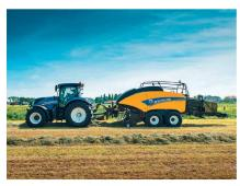
Afin de réduire les vibrations, New Holland propose sur les tracteurs de la série «T7» un mode «presse». Celui-ci permet de modifier le réglage de la suspension de l'essieu avant, d'accroître le couple moteur, et ainsi, de considérablement diminuer le balancement de l'attelage.
