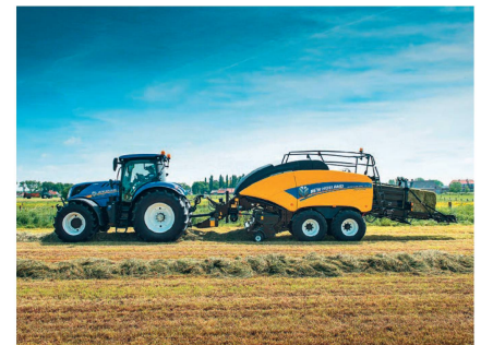
Afin de réduire les vibrations, New Holland propose sur les tracteurs de la série «T7» un mode «presse». Celui-ci permet de modifier le réglage de la suspension de l'essieu avant, d'accroître le couple moteur, et ainsi, de considérablement diminuer le balancement de l'attelage.
