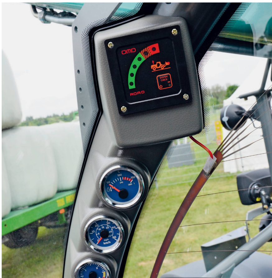
Le limiteur de couple de charge déclenche une alarme lorsque la stabilité d'un chargeur télescopique devient précaire. Photo : Ruedi Hunger
