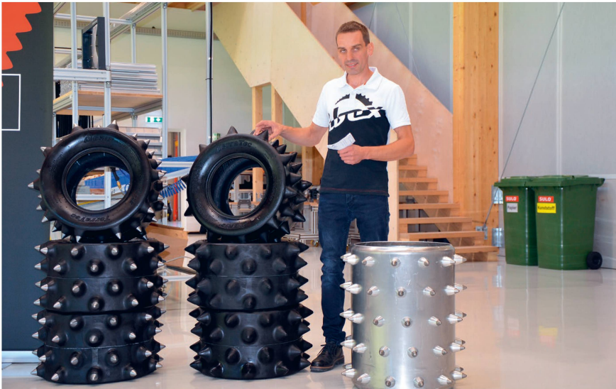
Lukas Schrottenbaum retrace l'histoire de sa production: des roues à ergots en aluminium à celles en caoutchouc, sans et avec des pointes en acier (de droite à gauche).
