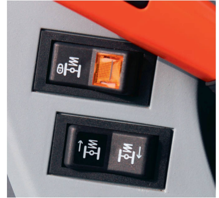
Le bouton supérieur permet de régler l'intensité de la suspension, et le bouton inférieur sert à régler la course de la suspension.
