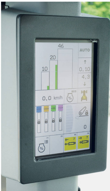
L'écran couleur « CIS+ » sur le montant avant droit offre une vue synoptique sur les réglages en fonction et sur les trois plages d'allure virtuelles.
