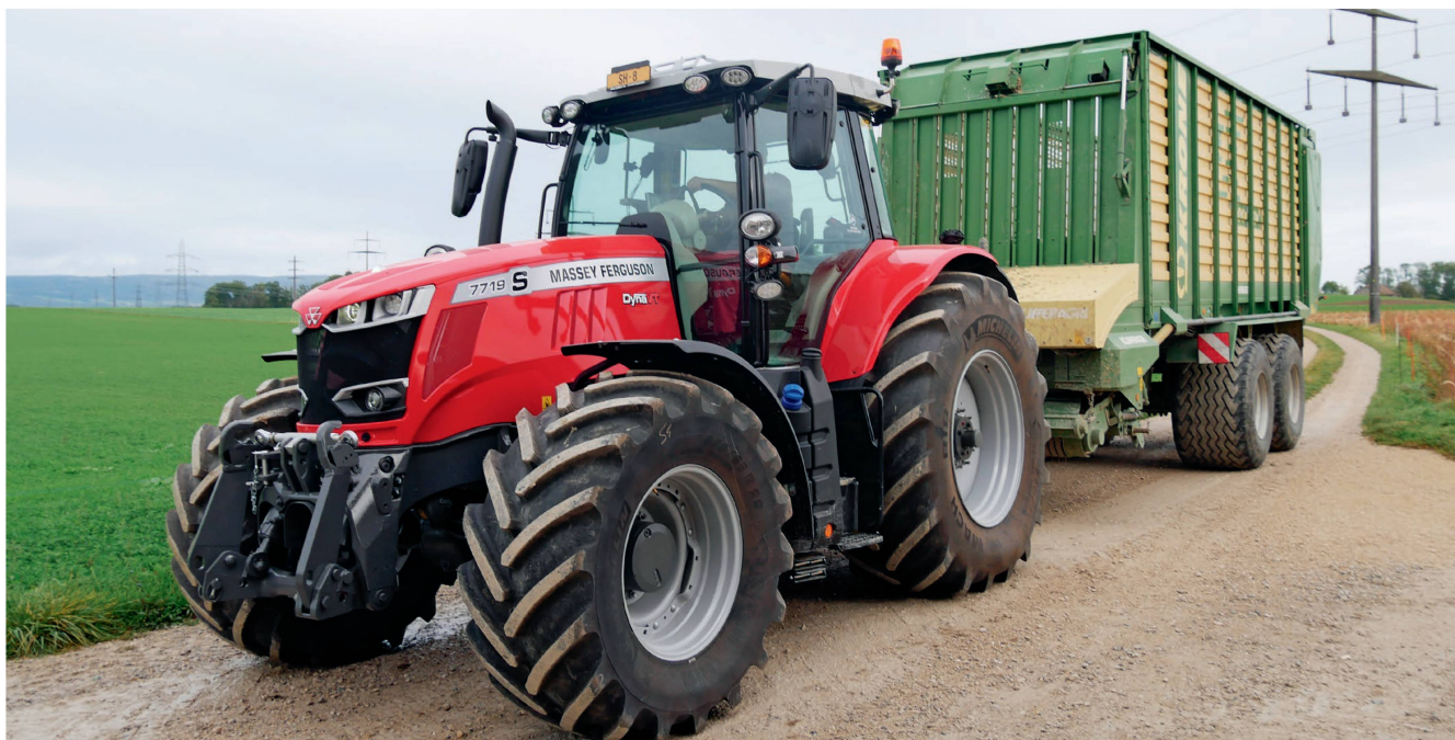
Le MF « 7719 S », avec le nouveau moteur de 6,6 litres développant 190 chevaux, la norme d'émission étape 5 et la transmission à variation continue « Dyna VT », est le nouveau navire amiral de la série « 7700 ». Photos: Heinz Röthlisberger
