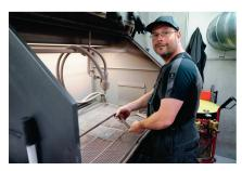
Dérouillage d'une pièce dans la cabine de sablage, qui sert aussi au décapage.
