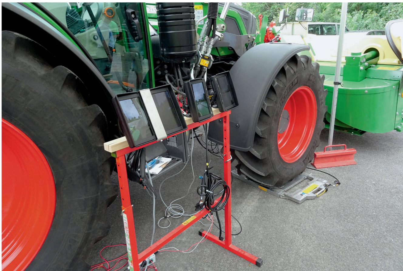
Des systèmes de caméras pourront peut-être à l'avenir permettre d'augmenter le porte-à-faux avant en assurant la sécurité. Certaines contraintes subsistent, dues à la charge admissible de l'essieu ou à la capacité de charge des pneus, et limitent cette extension possible pour les petits et moyens tracteurs. Photo: Roman Engeler
