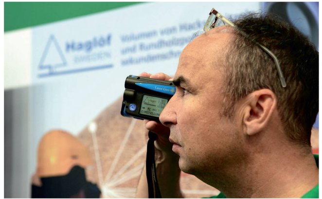
... ou avec un appareil laser qui permet de calculer les volumes des matériaux en vrac.
