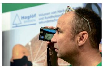
... ou avec un appareil laser qui permet de calculer les volumes des matériaux en vrac.
