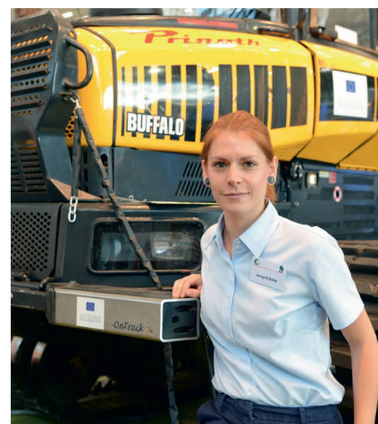
Une abatteuse équipée de scanner du sol identifie et documente à chaque passage l'état des layons de débardage.
