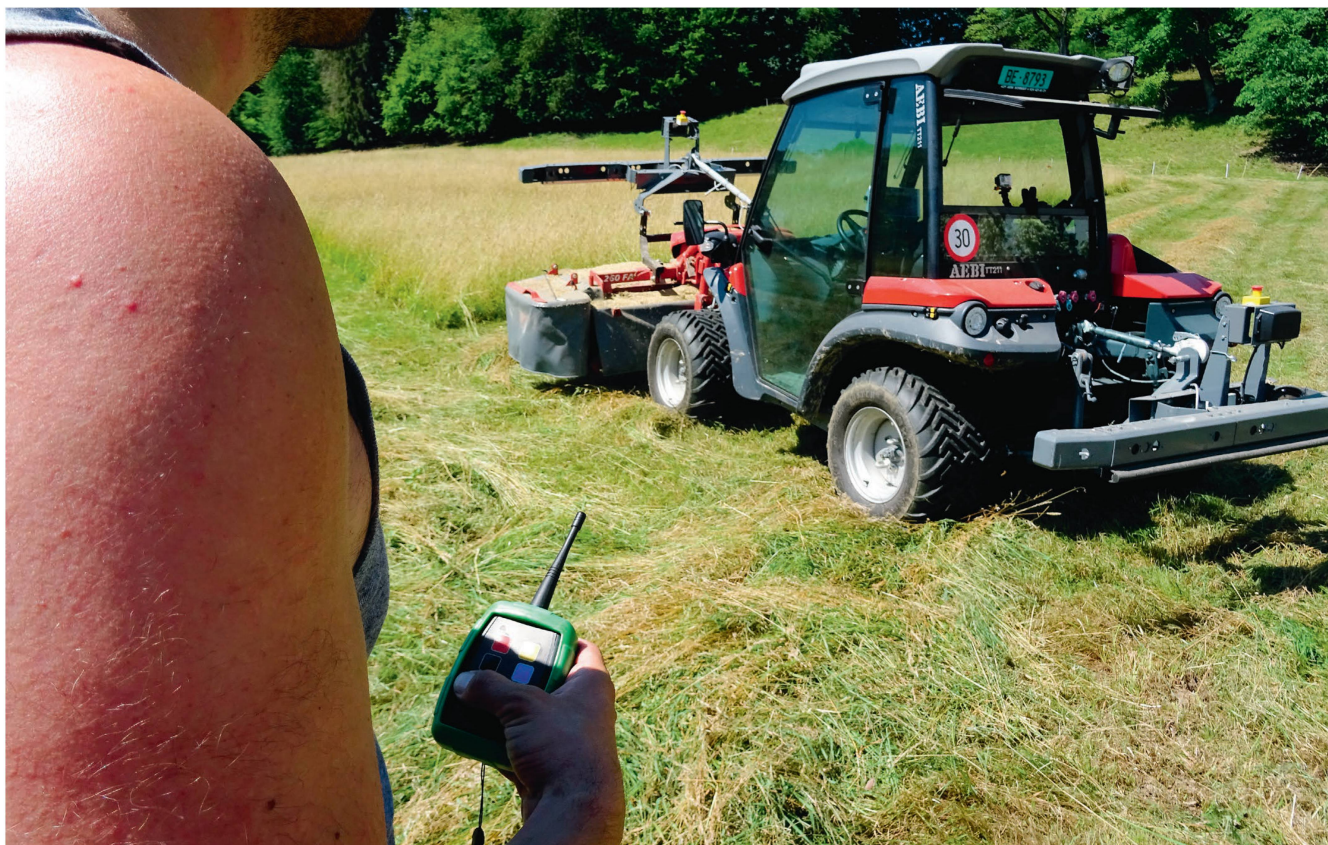
Le porte-outils Aebi « TT 211 » fauche les herbes hautes de manière autonome. L'opérateur peut démarrer ou stopper la machine par simple pression de bouton sur un petit boîtier. Photos: Roman Engeler
