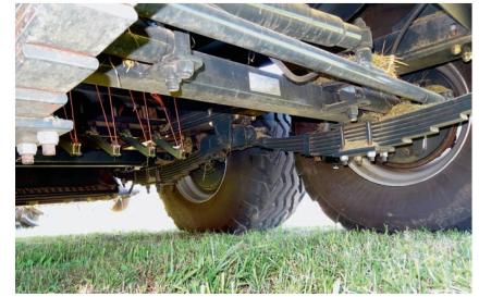
Ce modèle est équipé de pneumatiques de dimension 620/50-22.5 et d'un essieu tandem suiveur (verrouillable).
