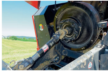
Les composants de l'entraînement, tels ici le volant d'inertie, sont robustes et construits pour un haut débit et de fortes densités.
