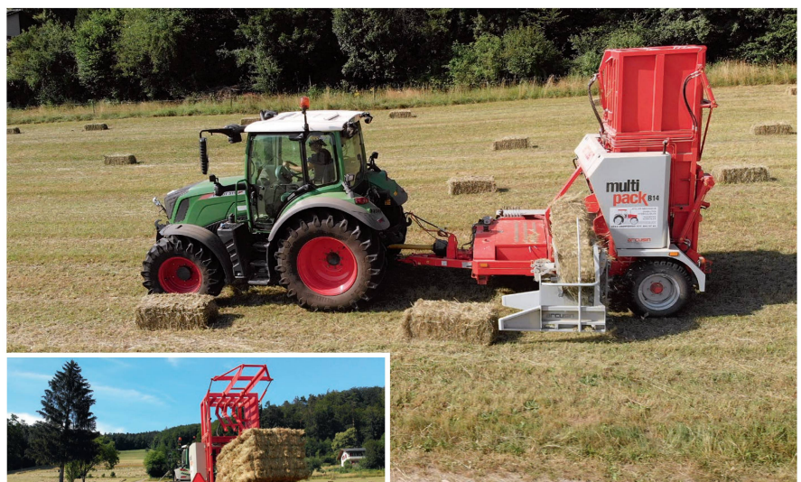
Avec sa chambre de pressage verticale, l'Arcusin « Multipack » offre une vue bien dégagée sur l'ensemble du processus.
