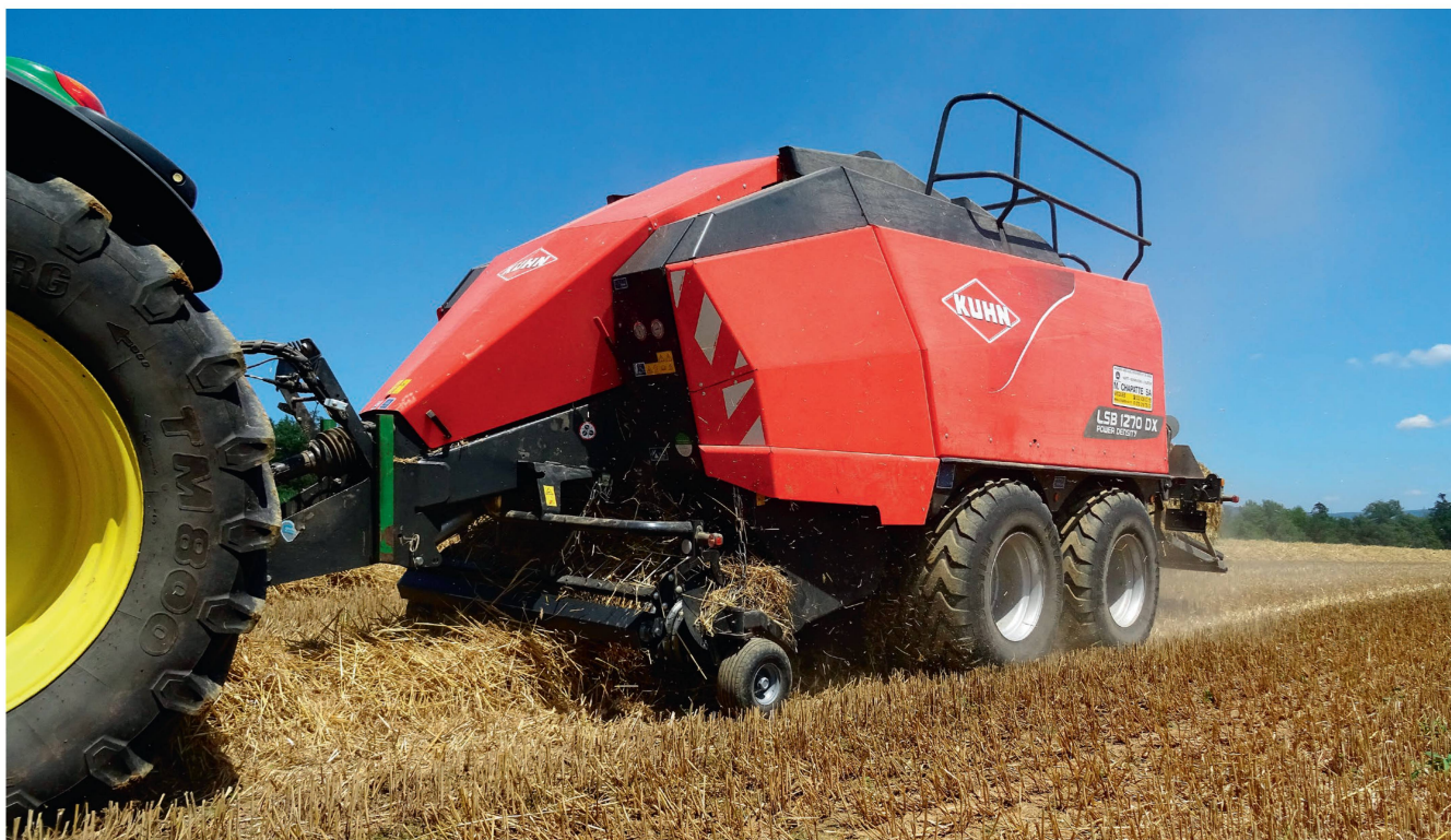
La presse à balles parallélépipédiques « LSB 1270 DX » a été mise sur le marché par Kuhn en 2017. Elle est spécialement conçue pour les balles « dures » de dimensions 120 x 70 cm. Photos : Roman Engeler
