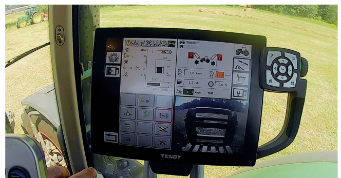
La presse à balle compatible Isobus se commande facilement depuis le terminal du tracteur.
