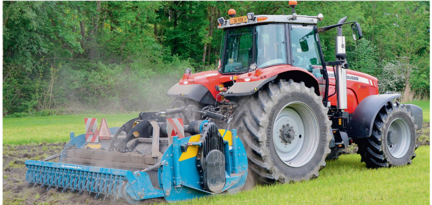
L'entraînement se fait par un engrenage plat sur le côté droit de la machine. L'outil suiveur est un rouleau packer à dents.
