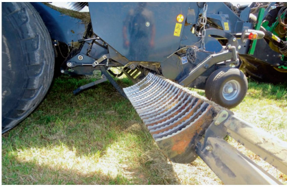
La cassette de 23 couteaux se coulisse aisément sur le côté de la machine pour l'entretien.
