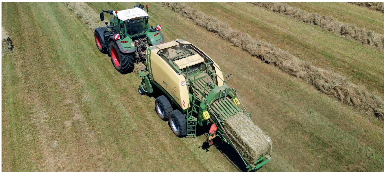
Lorsque la fonction «MultiBale» est active, la «Big Pack 870 HDP XC HighSpeed» réalise un débit de récolte similaire à celui de deux à trois presses à petites balles HD. Photos: Ruedi Burkhalter
