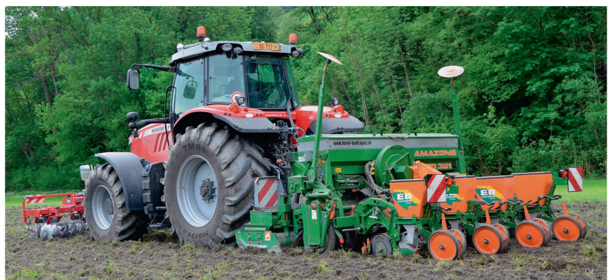
Ce cultivateur rotatif est combiné avec un semoir monograine. Photo: Ruedi Hunger
