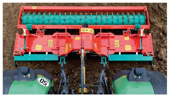
La herse rotative occupe une place prédominante au sein des appareils de travail du sol entraînés par prise de force. Photo: Kverneland
