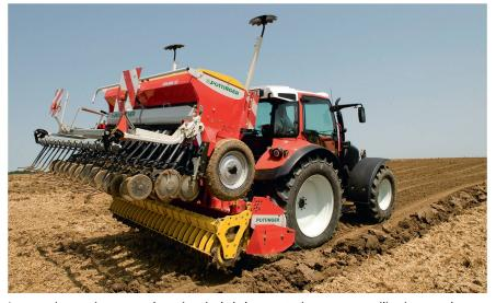
Les semoirs portés peuvent être séparés de la herse rotative pour une utilisation en solo. Photo: Pöttinger
