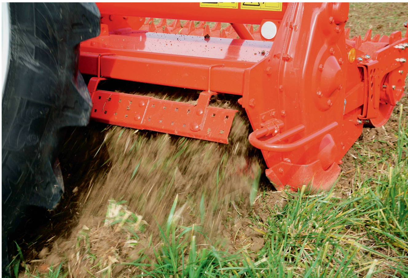
Les outils rotatifs ont une action mélangeante. Photo : Kuhn
